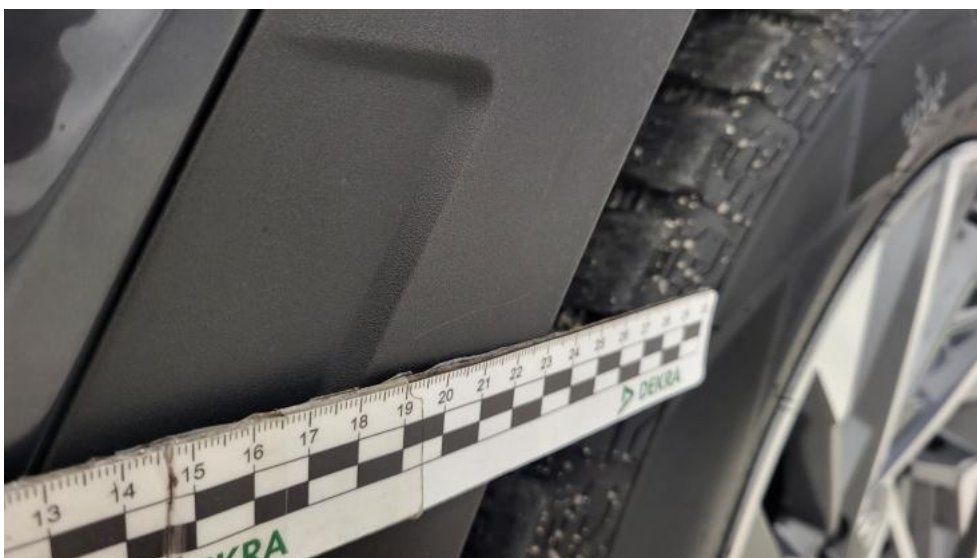
Fot. 40. Błotnik przedni P - Rysa/odprysk 1
