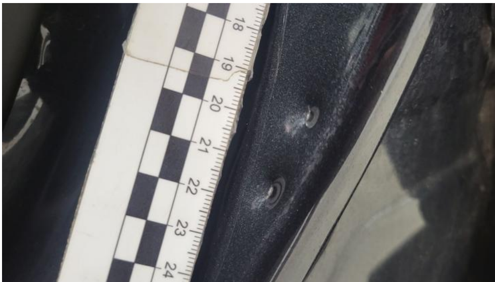
Fot. 51. Słupek środkowy L - Rysa/odprysk 1
