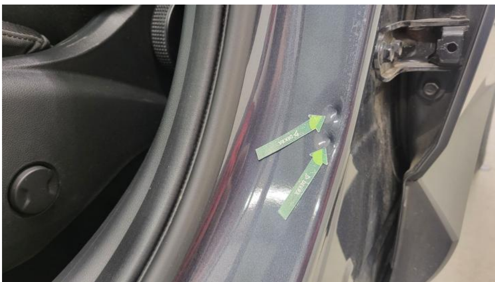
Fot. 52. Słupek środkowy L - Wgniecenie/odkształcenie 1
