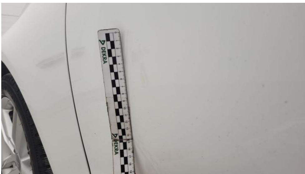
Photo 61. Drzwi przed L - Wgniecenie/odkształcenie 1
