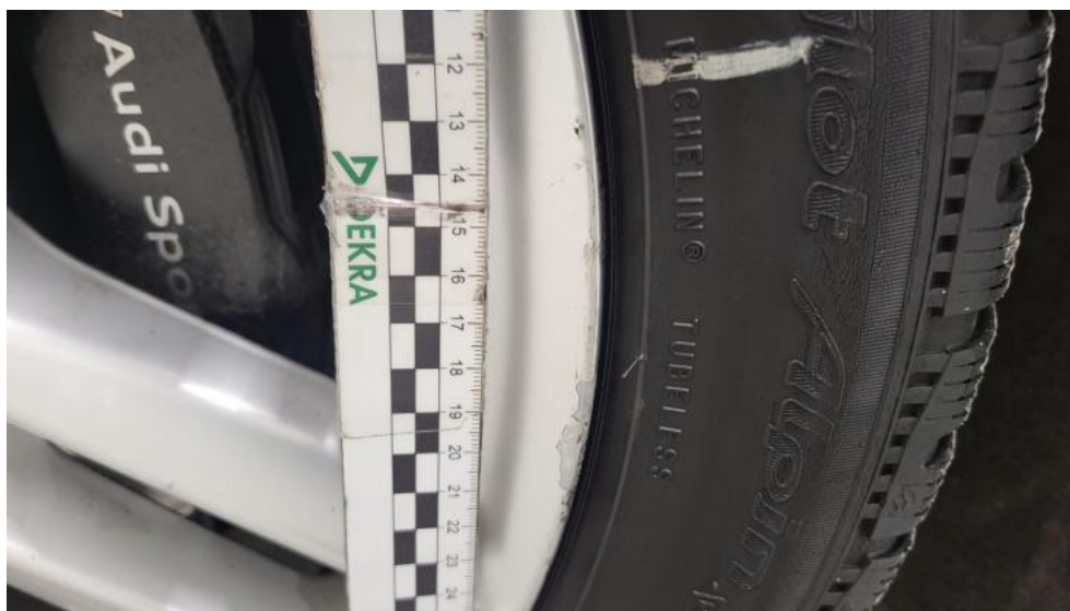
Photo 67. Felga Aluminiowa przednia L - Rysa/odprysk 2
