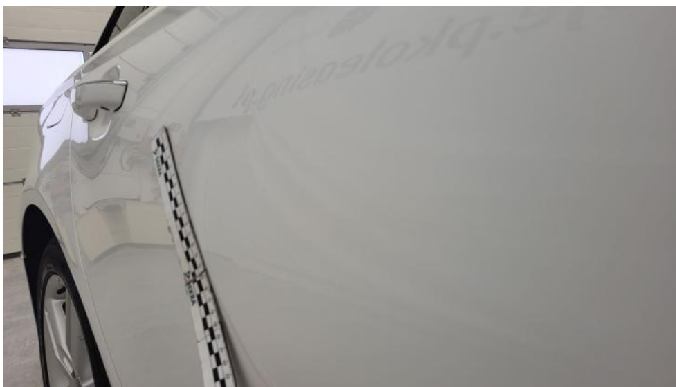
Photo 51. Drzwi tylne P - Wgniecenie/odkształcenie 1
