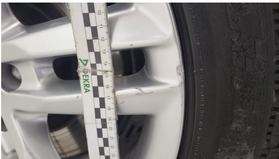
Photo 59. Felga aluminiowa tylna L - Rysa/odprysk 1
