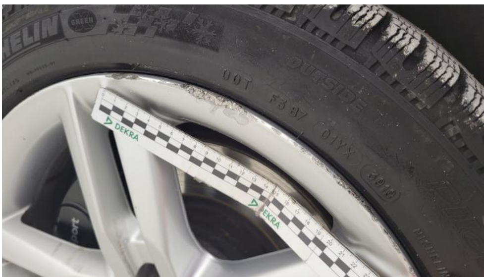
Photo 45. Felga aluminiowa przednia P - Rysa/odprysk 1
