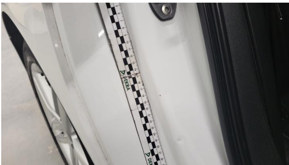
Photo 54. Błotnik tylny P / Ściana boczna P - Rysa/odprysk 1
