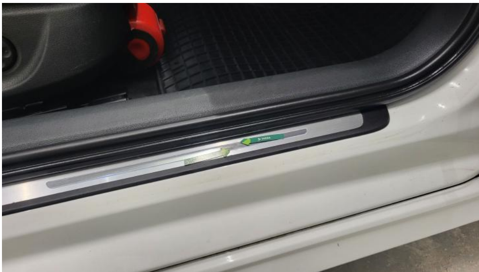
Photo 53. Próg P - Wgniecenie/odkształcenie 1
