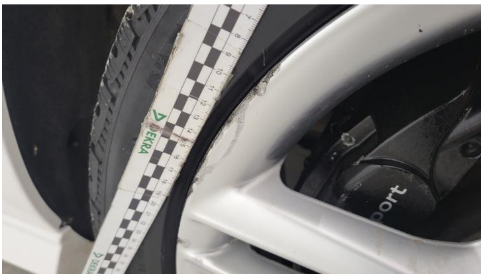
Photo 46. Felga aluminiowa przednia P - Rysa/odprysk 2
