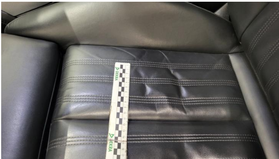
Photo 69. Fotel prz. lew. - Wgniecenie/odkształcenie 1
