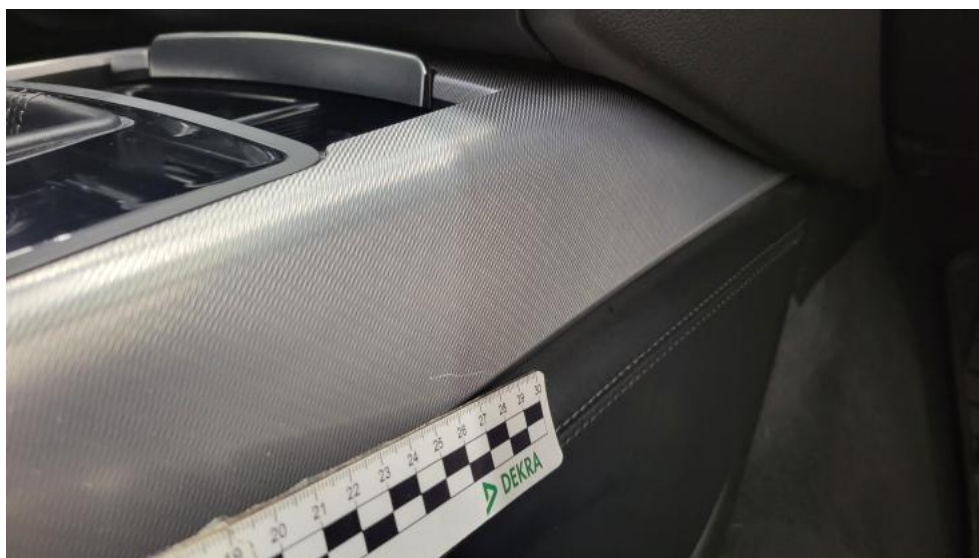
Photo 68. Konsola tunelu śr. - Rysa/odprysk 1
