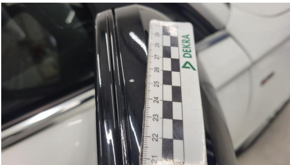
Photo 52. Lusterko zew P - Rysa/odprysk 1
