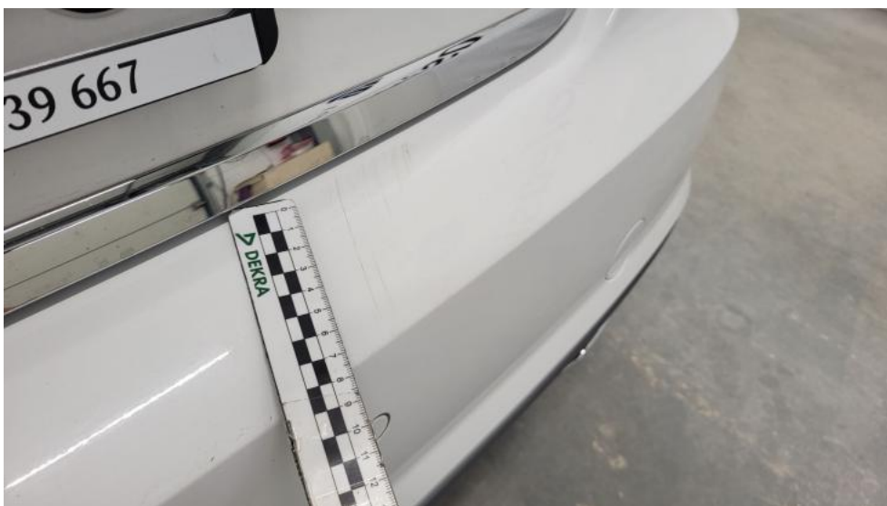
Photo 58. Zderzak tylny - Rysa/odprysk 1
