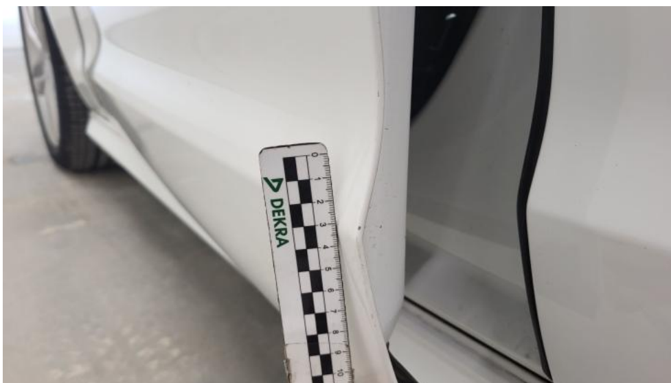
Photo 60. Drzwi przed L - Rysa/odprysk 1
