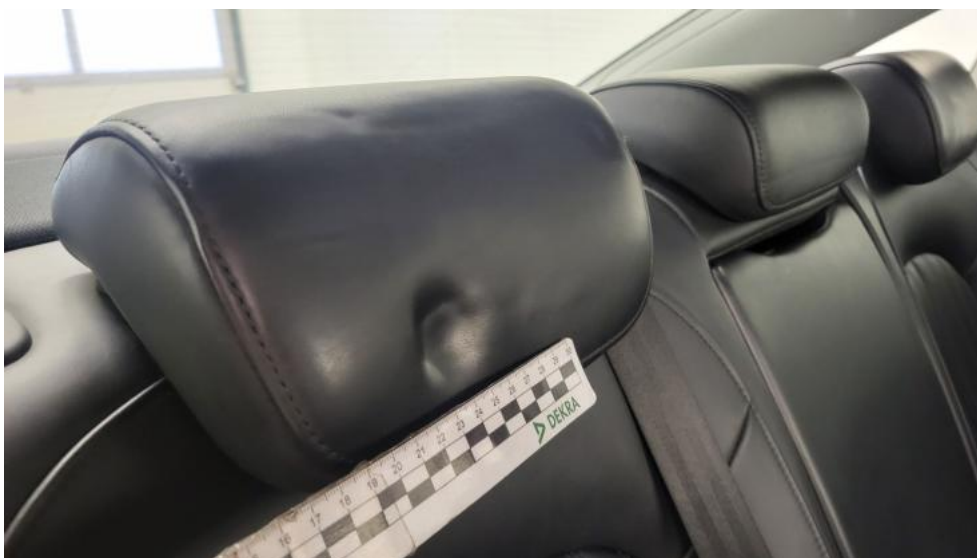
Photo 70. Zaglówek praw. kanapy tyl. - Wgniecenie/odkształcenie 1
