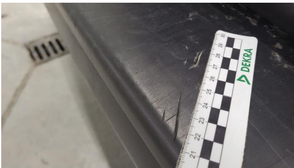
Photo 68. Zderzak tylny - Pęknięcie/rozerwanie 1
