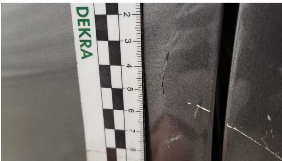
Photo 56. Drzwi przednie P - Pęknięcie/rozerwanie 1
