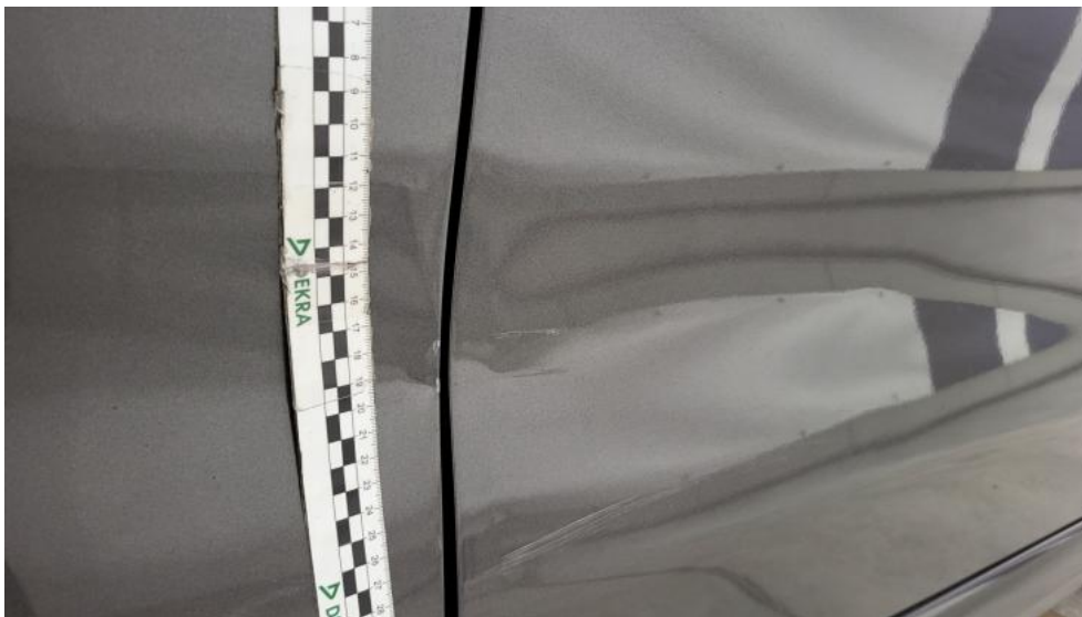
Photo 57. Drzwi tylne P - Rysa/odprysk 1
