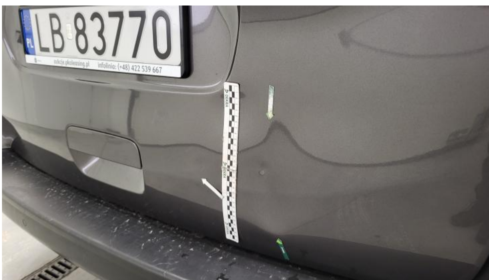
Photo 66. Pokrywy bagażnika - Wgniecenie/odkształcenie 1
