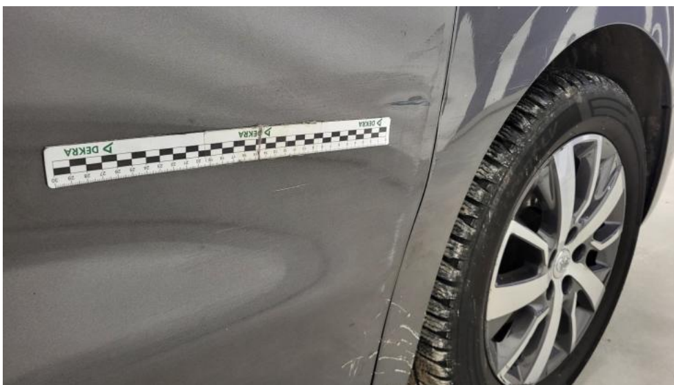
Photo 53. Drzwi przednie P - Rysa/odprysk 2
