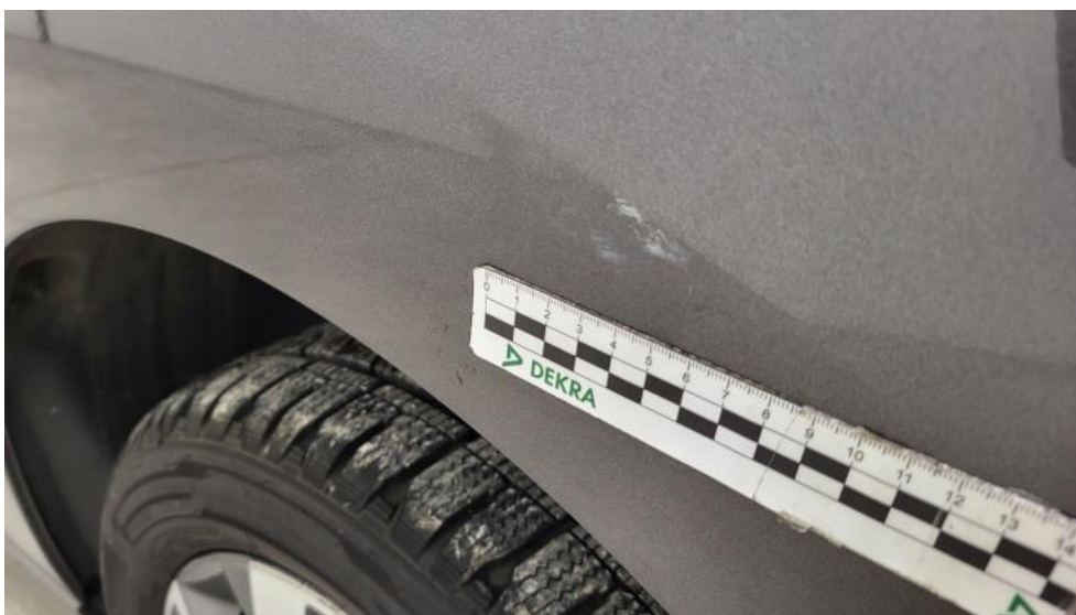
Photo 72. Błotnik tylny L / Ściana boczna L - Rysa/odprysk 1
