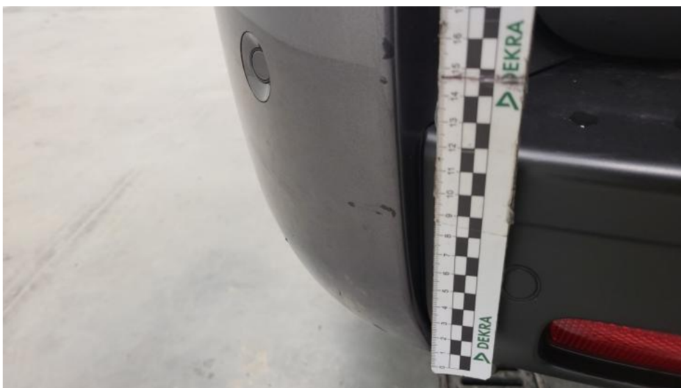
Photo 70. Zderzak tylny cz L - Rysa/odprysk 1
