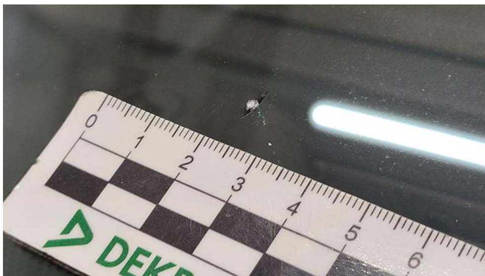
Photo 45. Szyba czołowa - Pęknięcie/rozerwanie 1
