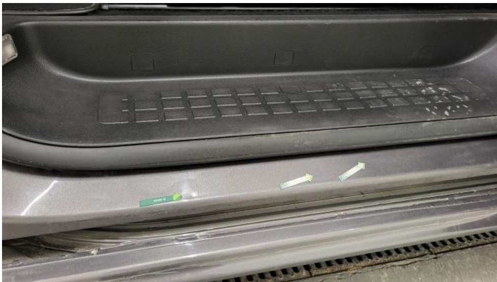
Photo 81. Próg L - Wgniecenie/odkształcenie 1
