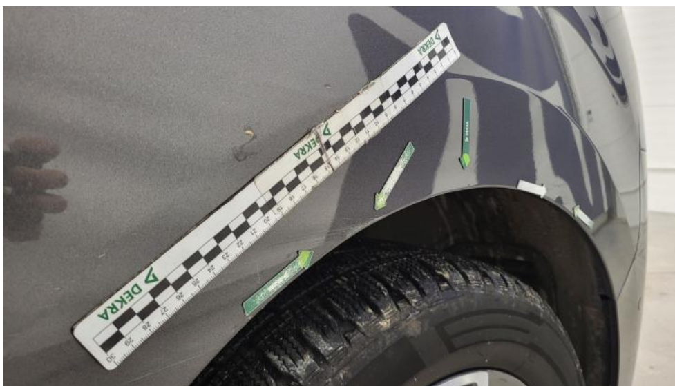
Photo 51. Błotnik przedni P - Wgniecenie/odkształcenie 2
