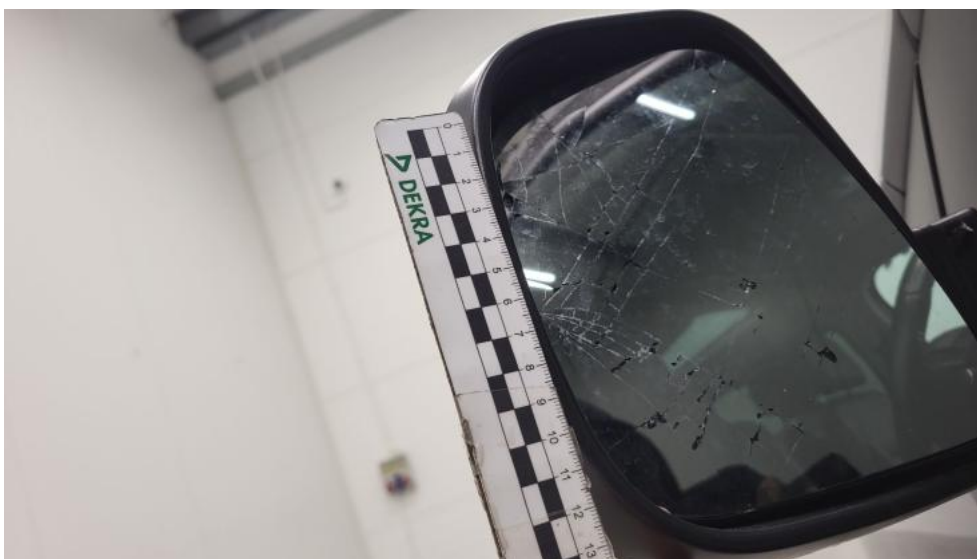
Photo 79. Lusterko zew L - Pęknięcie/rozerwanie 1
