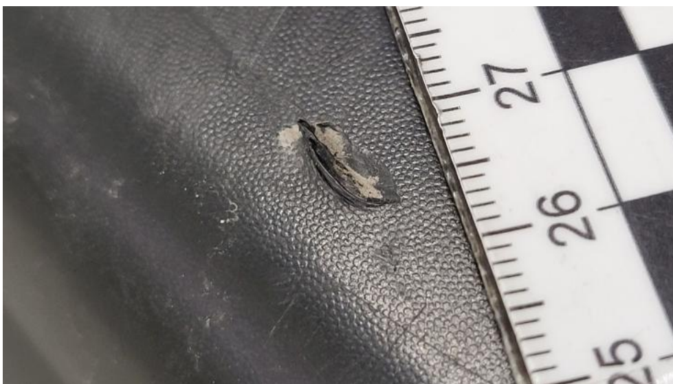
Photo 69. Zderzak tylny - Pęknięcie/rozerwanie 2
