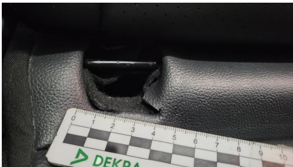
Photo 83. Kanapa tyl. - Pęknięcie/rozerwanie 1
