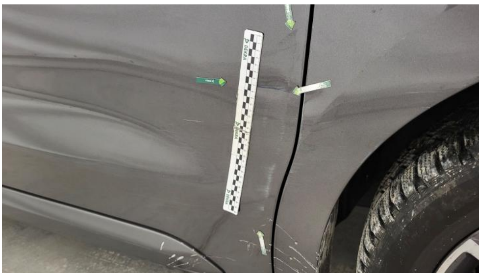
Photo 54. Drzwi przednie P - Wgniecenie/odkształcenie 1
