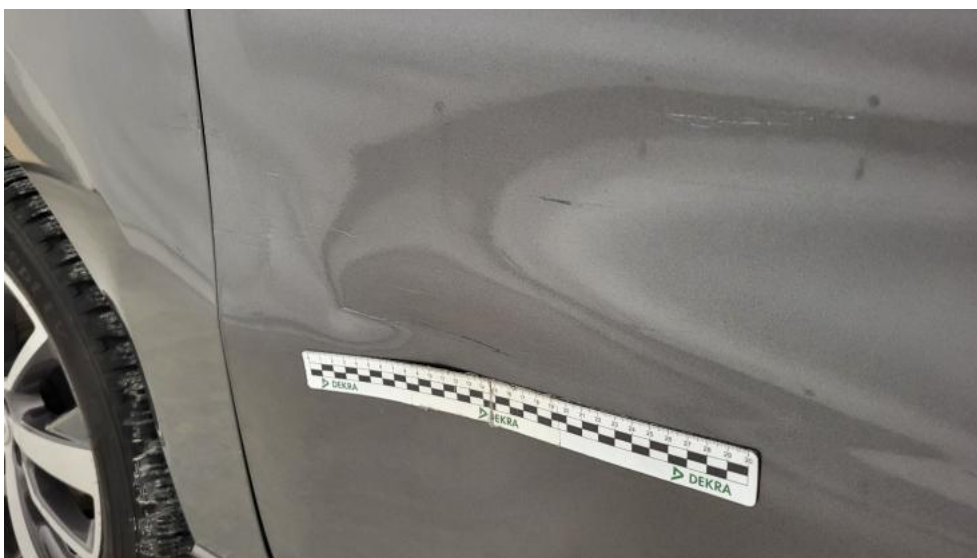
Photo 58. Drzwi tylne P - Rysa/odprysk 2
