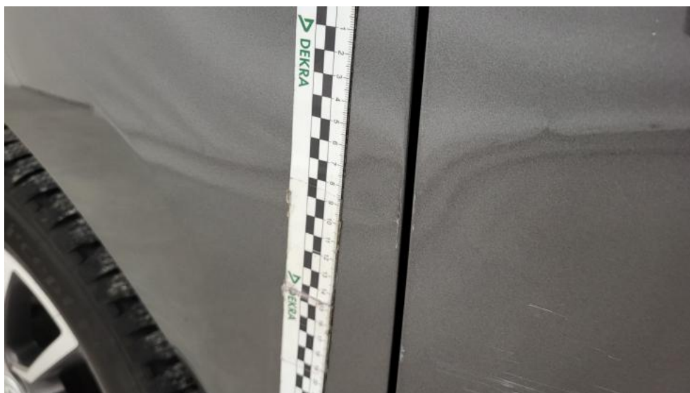
Photo 62. Błotnik tylny P / Ściana boczna P - Rysa/odprysk 1
