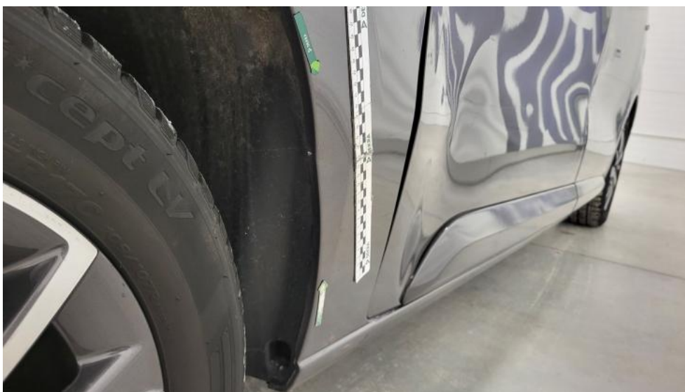
Photo 65. Błotnik tylny P / Ściana boczna P - Wgniecenie/odkształcenie 2
