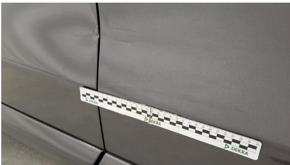
Photo 52. Drzwi przednie P - Rysa/odprysk 1
