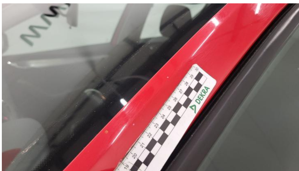
Fot. 78. Słupek przedni L - Rysa/odprysk 1
