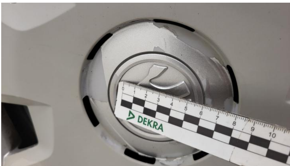
Fot. 83. Kołpak przedni L() - Rysa/odprysk 3
