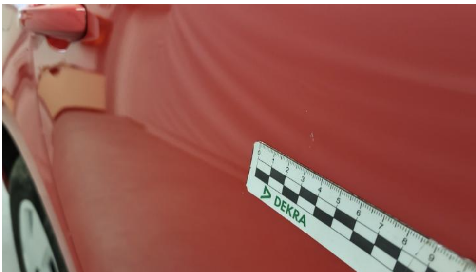
Fot. 54. Drzwi tylne P - Rysa/odprysk 1
