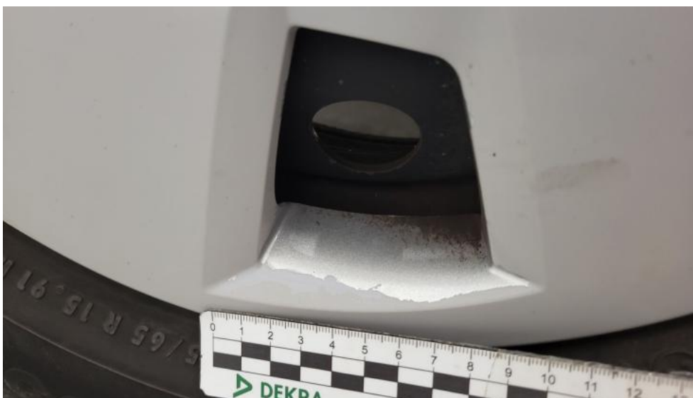
Fot. 59. Kołpak tylny P - Rysa/odprysk 1
