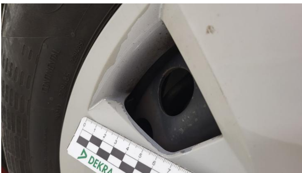
Fot. 82. Kołpak przedni L - Rysa/odprysk 2
