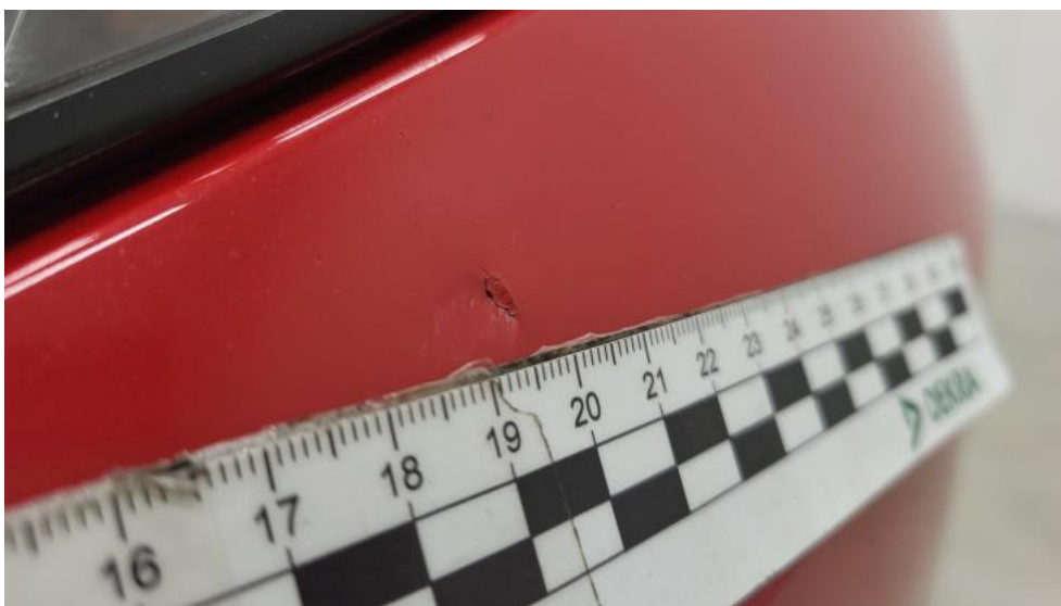
Fot. 44. Zderzak - Pęknięcie/rozerwanie 1
