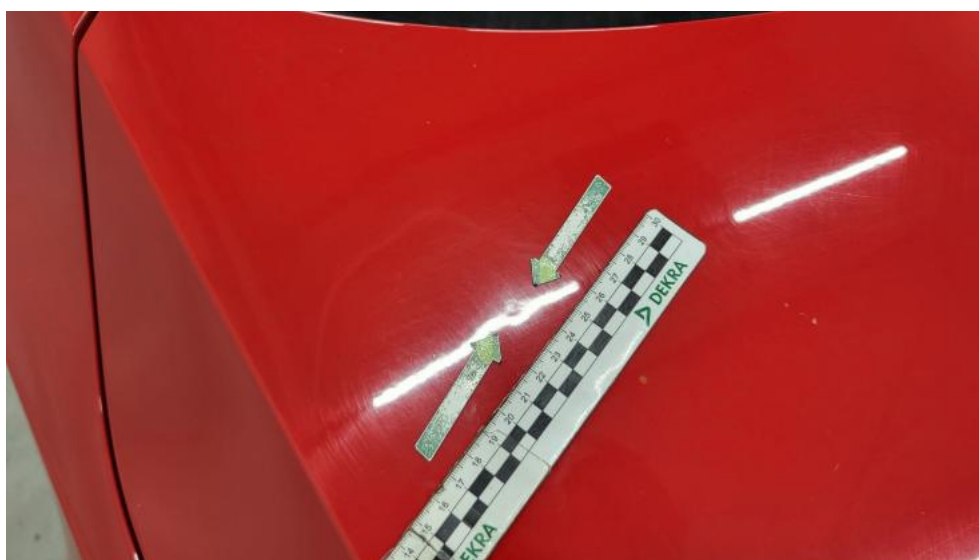
Fot. 38. Pokrywa komory silnika - Wgniecenie/odkształcenie 1
