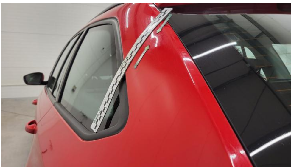
Fot. 66. Błotnik tylny L / Ściana boczna L - Wgniecenie/odkształcenie 1
