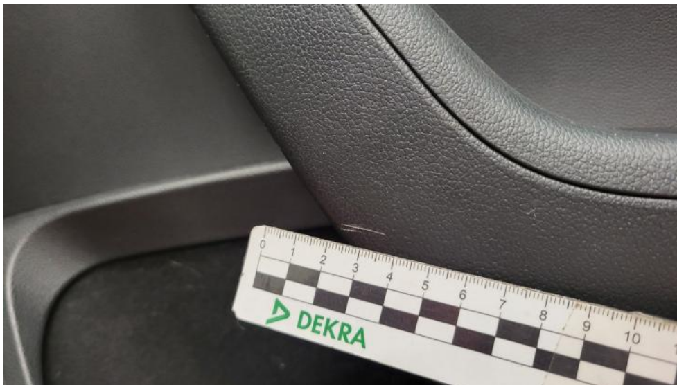
Fot. 87. Uchwyt drzwi prze P - Rysa/odprysk 1
