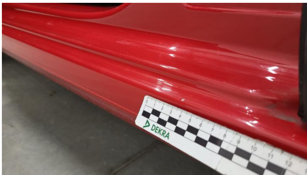
Fot. 77. Próg L - Rysa/odprysk 2
