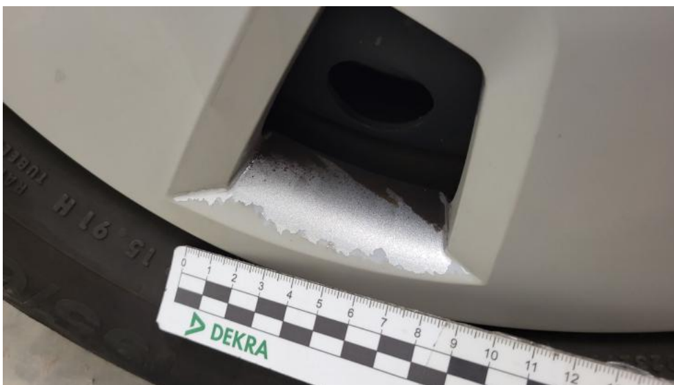
Fot. 81. Kołpak przedni L - Rysa/odprysk 1
