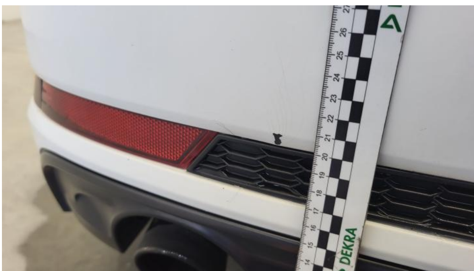
Fot. 52. Zderzak tylny - Pęknięcie/rozerwanie 2
