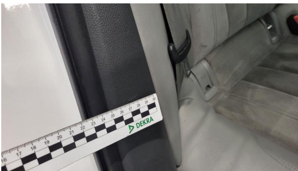
Fot. 72. Wykładzina(y) słupka tylnego P - Rysa/odprysk 1
