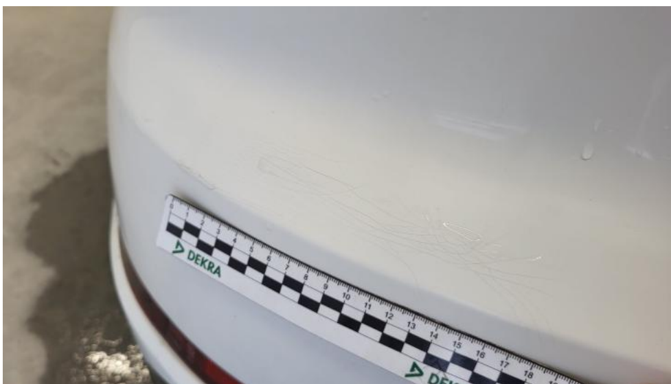
Fot. 51. Zderzak tylny - Pęknięcie/rozerwanie 1
