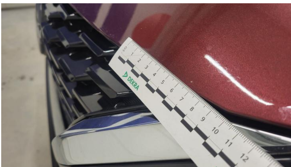
Fot. 38. Pokrywa komory silnika - Rysa/odprysk 1
