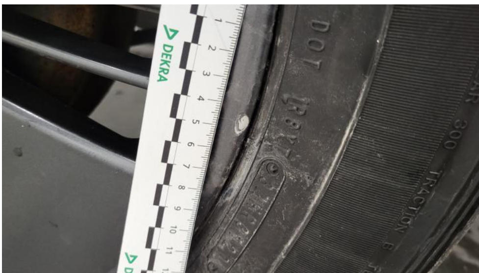
Fot. 48. Felga aluminiowa tylna P - Rysa/odprysk 1
