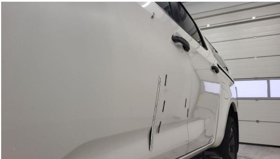
Fot. 55. Drzwi przed L - Wgniecenie/odkształcenie 1
