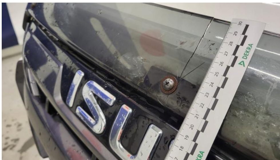
Fot. 38. Listwa śr zderzaka przedniego - Pęknięcie/rozerwanie 1
