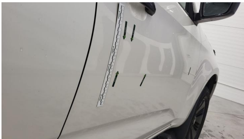
Fot. 44. Drzwi przednie P - Wgniecenie/odkształcenie 1
