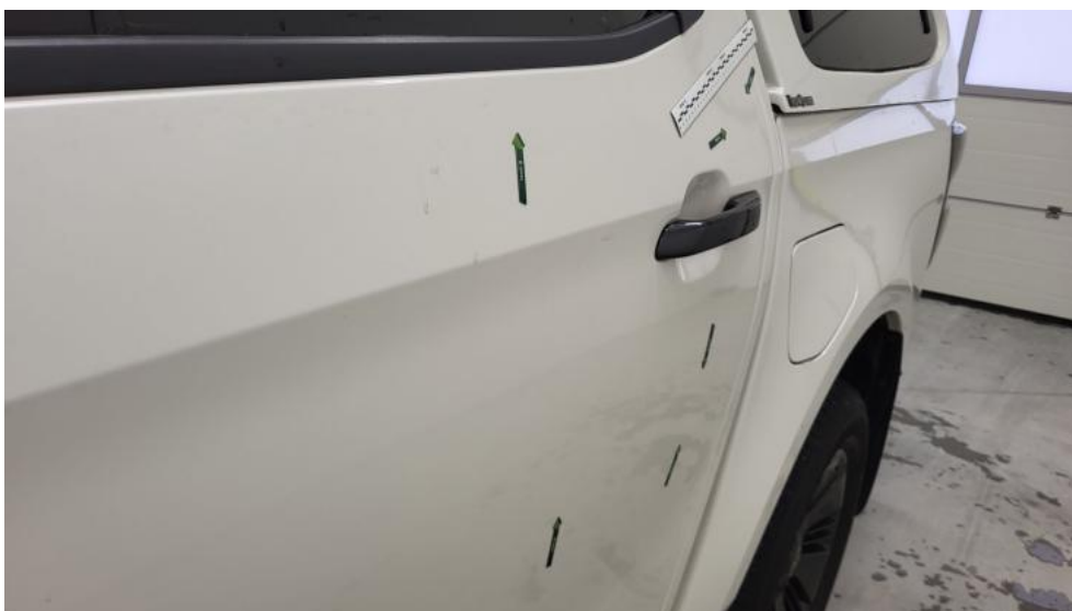
Fot. 56. Drzwi tylne L - Wgniecenie/odkształcenie 1
