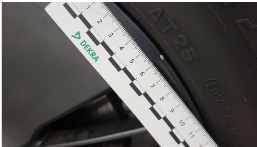
Fot. 43. Felga aluminiowa przednia P - Rysa/odprysk 1
