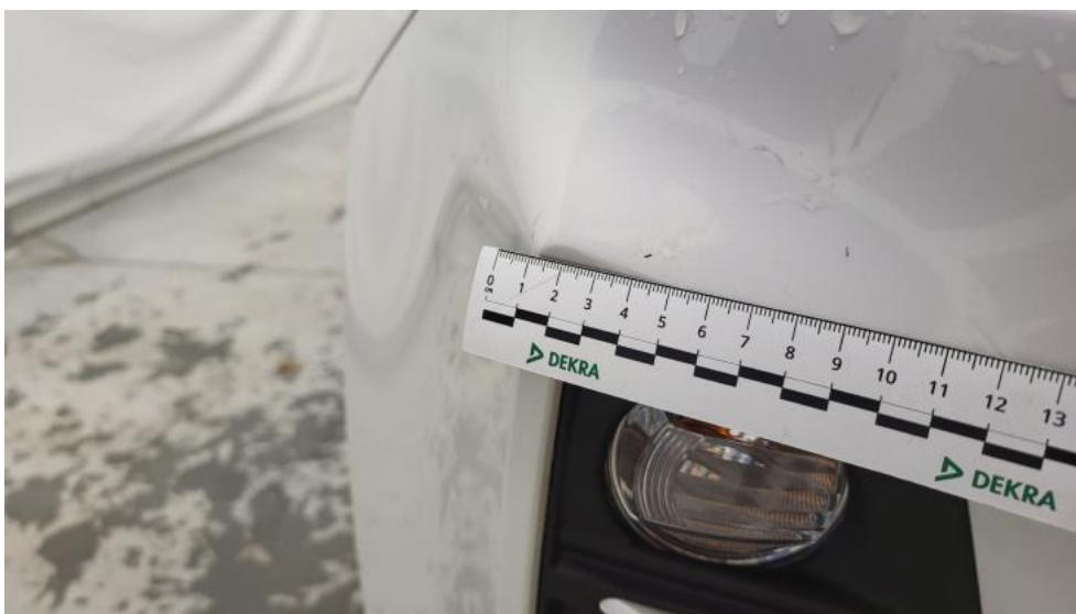
Fot. 42. Zderzak - Rysa/odprysk 1
