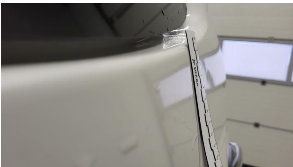
Fot. 52. Błotnik tylny L / Ściana boczna L - Wgniecenie/odkształcenie 1
