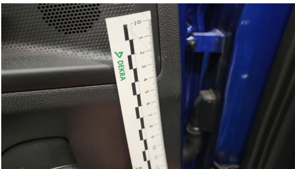
Fot. 56. Tapicerka drzwi tylnych L - Wgniecenie/odkształcenie 1
