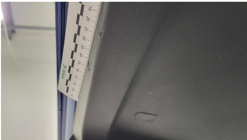
Fot. 58. Wykładzina pokrywy tylnej - Rysa/odprysk 1
