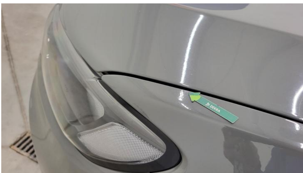
Fot. 60. Błotnik przedni L - Wgniecenie/odkształcenie 1
