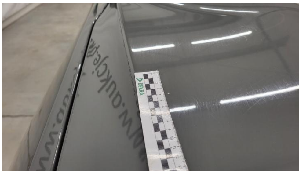
Fot. 36. Pokrywa komory silnika - Rysa/odprysk 1
