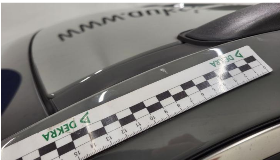
Fot. 59. Słupek przedni L - Rysa/odprysk 1
