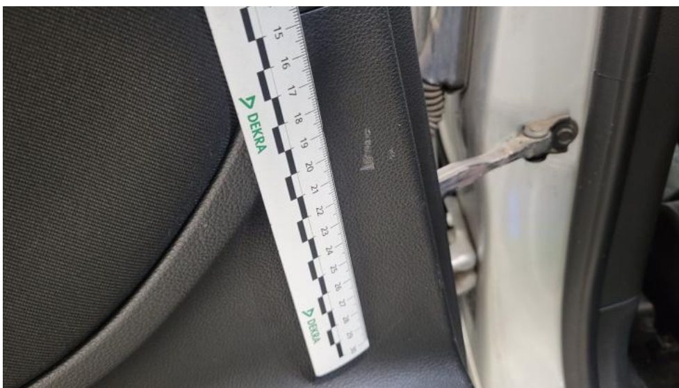
Photo 75. Tapicerka drzwi tylnych L - Rysa/odprysk 1
