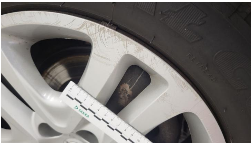
Photo 58. Kołpak tylny L - Rysa/odprysk 1
