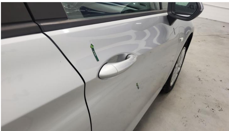
Photo 43. Drzwi przednie P - Wgniecenie/odkształcenie 1
