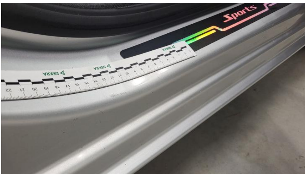
Photo 47. Próg P - Rysa/odprysk 1
