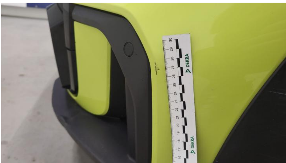
Fot. 52. Zderzak przedni cz L - Rysa/odprysk 1
