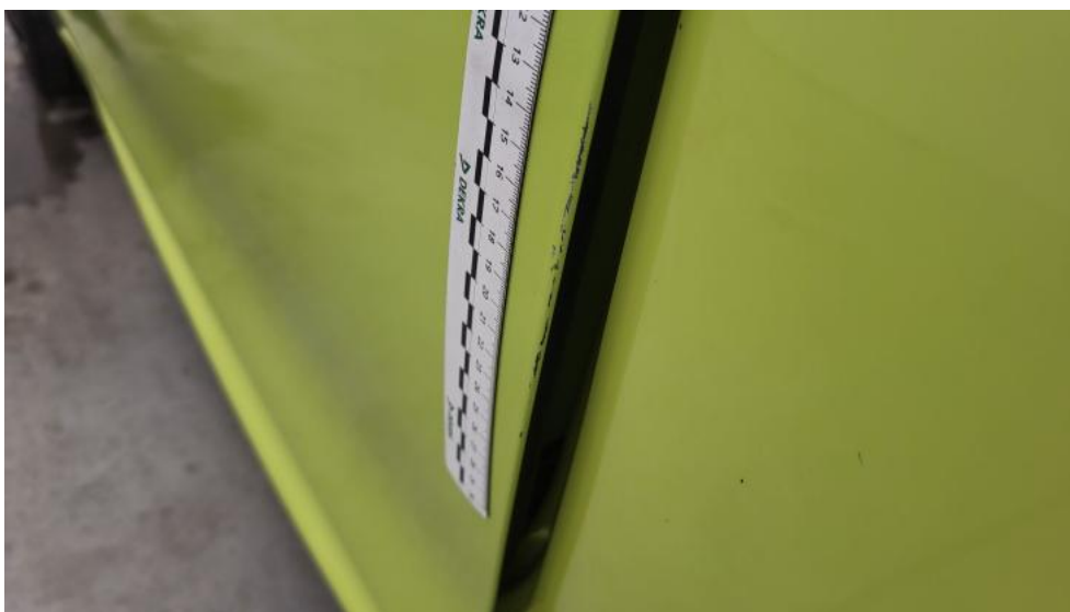
Fot. 73. Drzwi przed L - Rysa/odprysk 1
