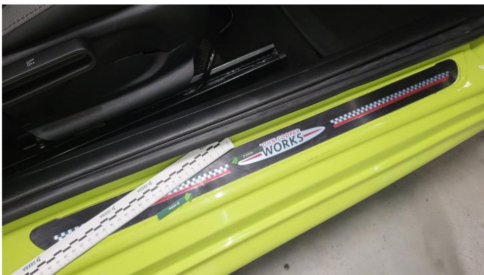
Fot. 60. Próg P - Wgniecenie/odkształcenie 1
