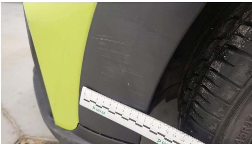
Fot. 78. Listwa błotnika przedniego L - Rysa/odprysk 1
