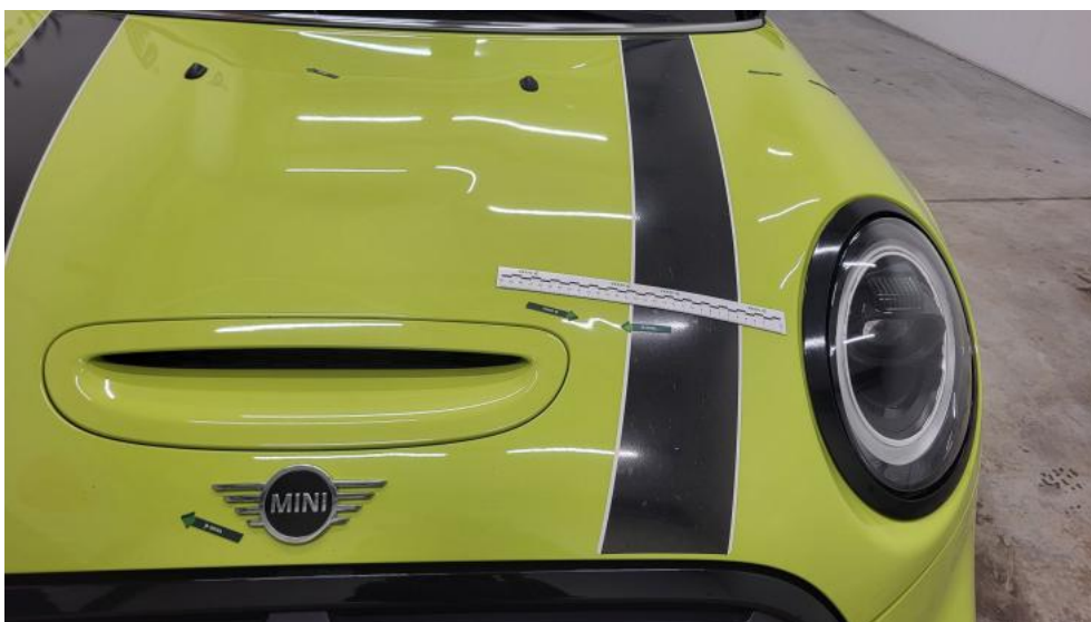
Fot. 48. Pokrywa komory silnika - Wgniecenie/odkształcenie 1
