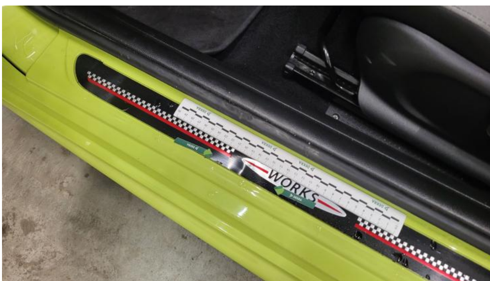
Fot. 76. Próg L - Wgniecenie/odkształcenie 1
