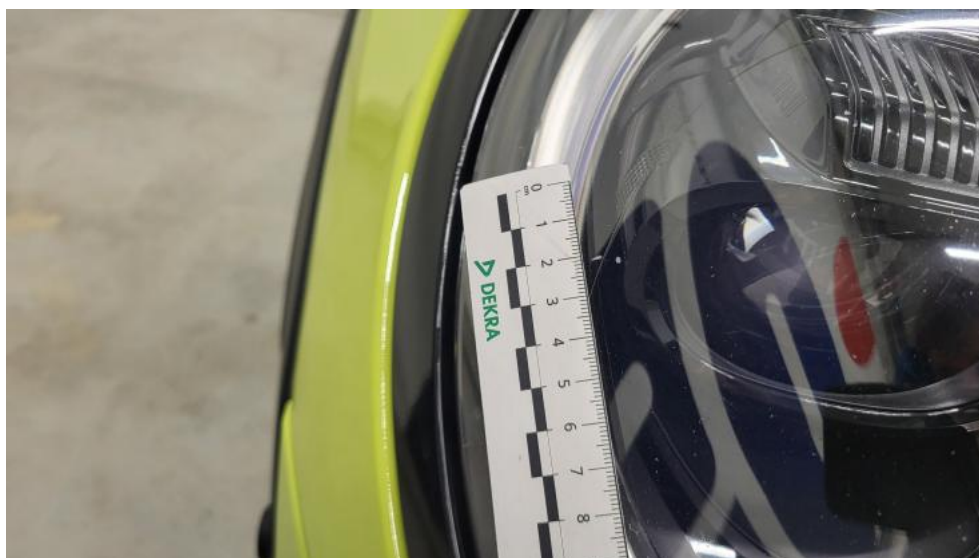
Fot. 56. Reflektor P - Rysa/odprysk 1
