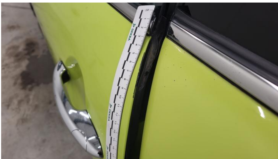
Fot. 74. Drzwi przed L - Rysa/odprysk 2
