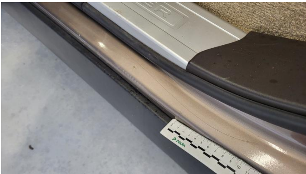
Fot. 93. Próg L - Rysa/odprysk 1
