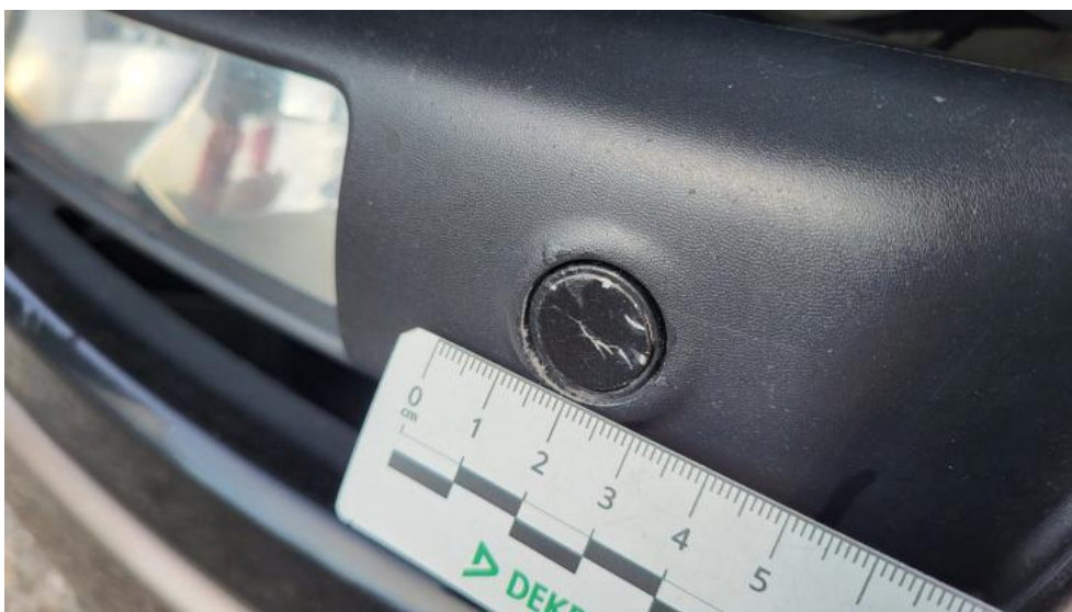
Fot. 48. Czujniki parkowania przód - Rysa/odprysk 1
