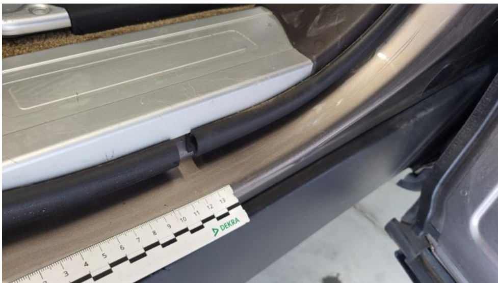
Fot. 71. Próg P - Rysa/odprysk 2
