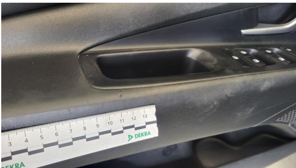
Photo 108. Tapicerka drzwi przednich L - Pęknięcie/rozerwanie 1
