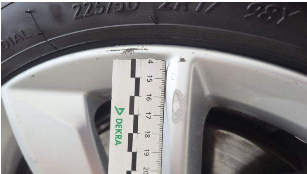
Fot. 56. Felga aluminiowa przednia P - Rysa/odprysk 1
