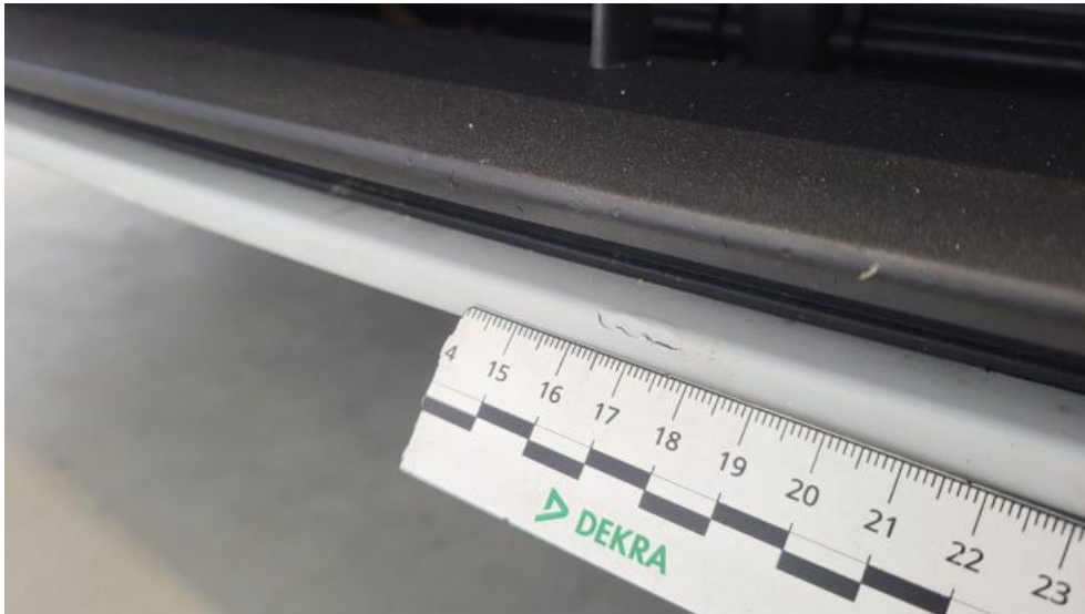
Fot. 55. Zderzak - Pęknięcie/rozerwanie 1
