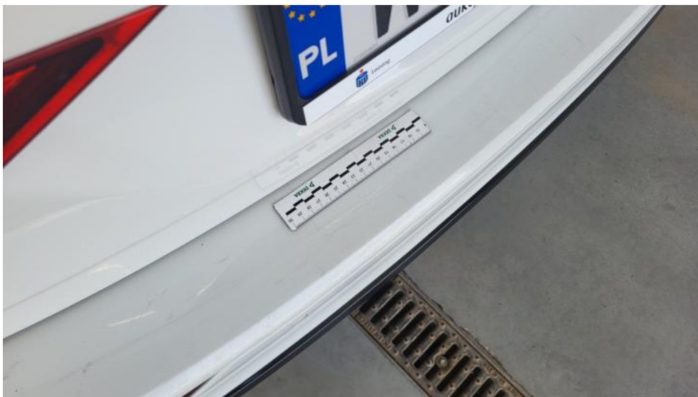
Fot. 67. Zderzak tylny - Wgniecenie/odkształcenie 1
