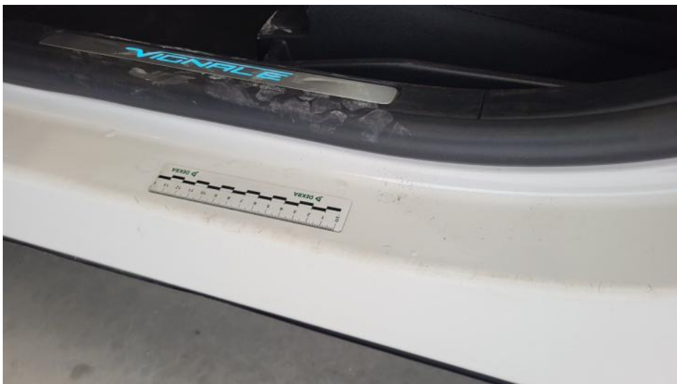
Photo 59. Próg L - Rysa/odprysk 1
