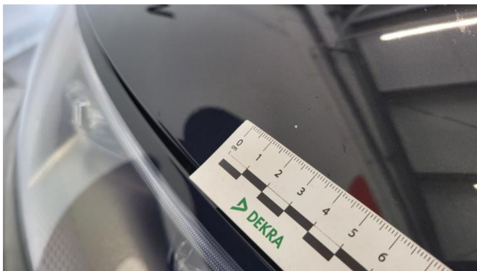
Fot. 44. Pokrywa komory silnika - Rysa/odprysk 1
