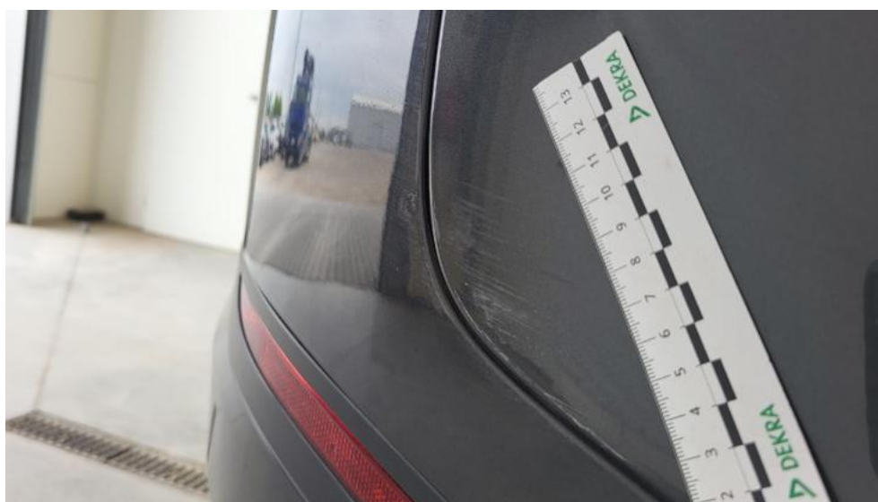
Fot. 54. Błotnik tylny P / Ściana boczna P - Rysa/odprysk 2
