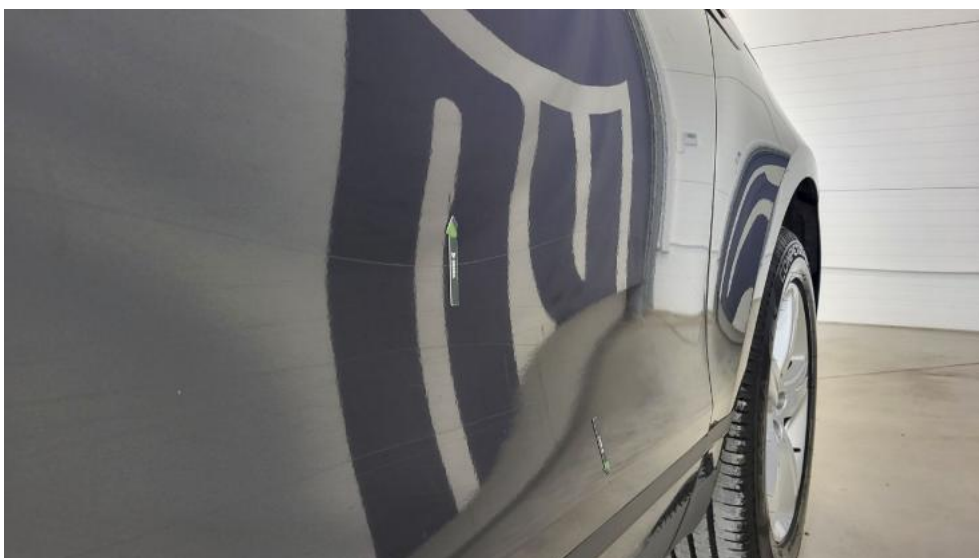
Fot. 48. Drzwi przednie P - Wgniecenie/odkształcenie 1
