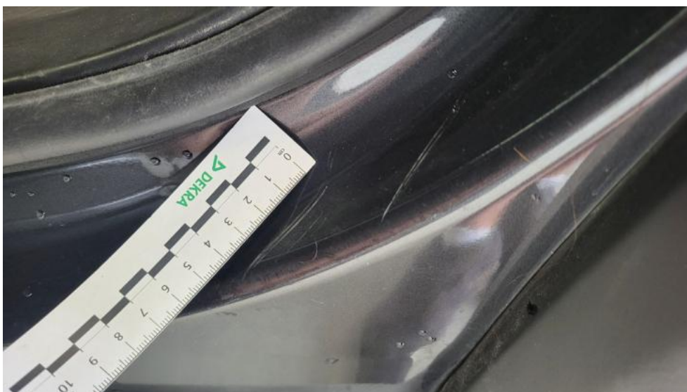
Fot. 72. Próg L - Rysa/odprysk 1
