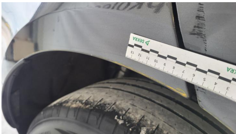
Fot. 53. Błotnik tylny P / Ściana boczna P - Rysa/odprysk 1
