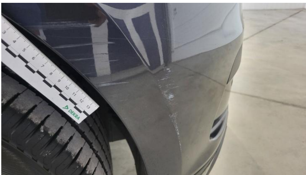
Fot. 43. Zderzak - Rysa/odprysk 2
