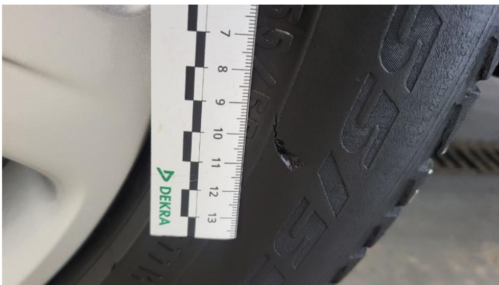
Fot. 73. Opona przednia L - Pęknięcie/rozerwanie 1
