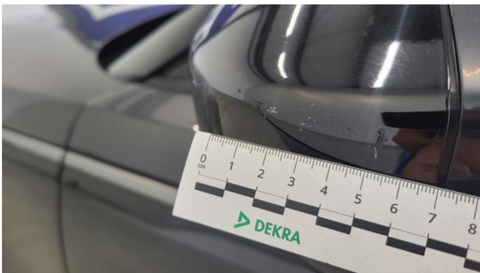
Fot. 71. Lusterko zew L - Rysa/odprysk 1
