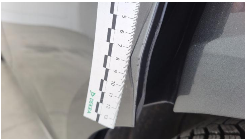
Photo 66. Drzwi tylne L - Rysa/odprysk 1
