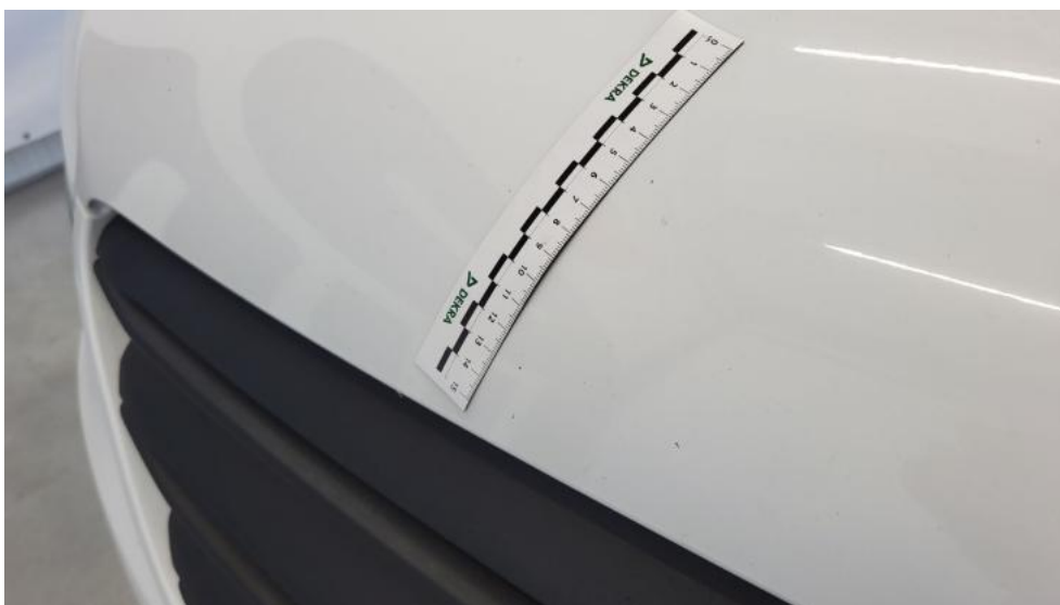
Fot. 40. Pokrywa komory silnika - Rysa/odprysk 1
