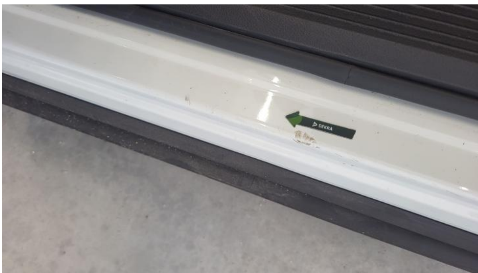
Fot. 45. Próg L - Wgniecenie/odkształcenie 1
