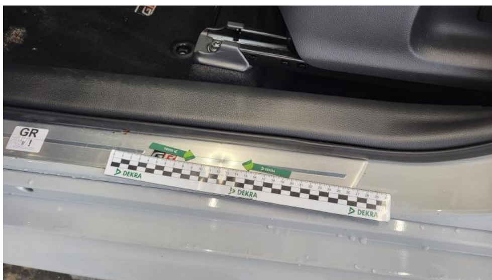
Photo 50. Próg L - Wgniecenie/odkształcenie 1
