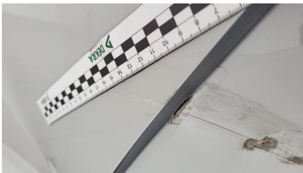
Photo 48. Drzwi tylne L - Rysa/odprysk 1
