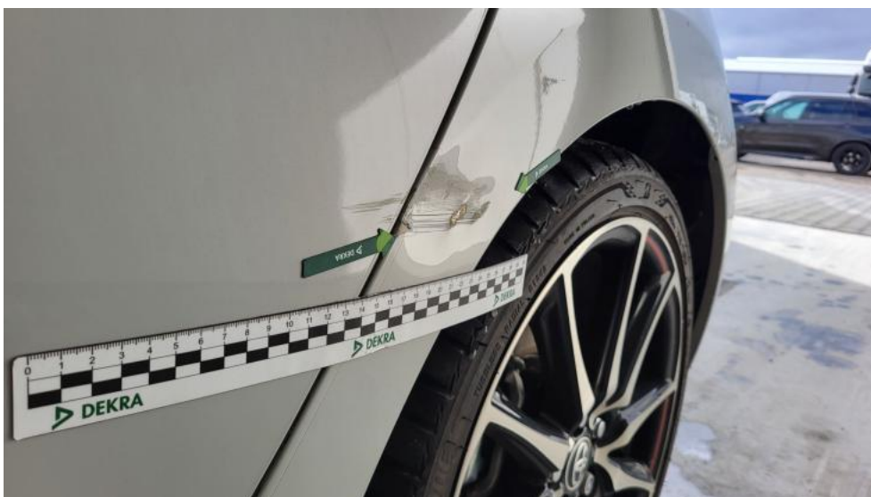
Photo 46. Błotnik tylny L / Ściana boczna L - Wgniecenie/odkształcenie 1
