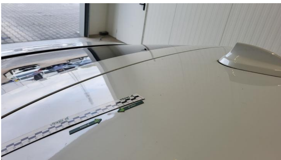
Fot. 62. Dach - Wgniecenie/odkształcenie 1
