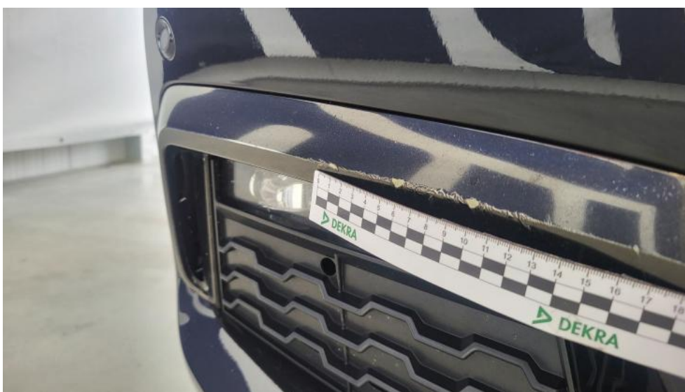
Fot. 44. Kratka/zaślepka halogenu P - Rysa/odprysk 1
