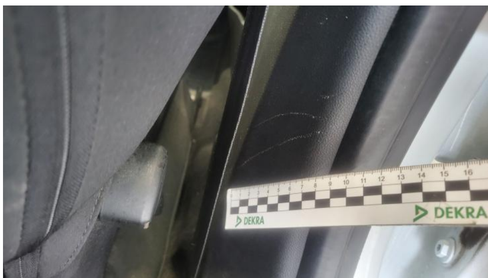
Fot. 72. Wykładzina(y) słupka środkowego P - Rysa/odprysk 1
