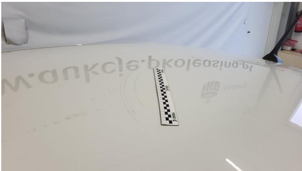
Fot. 53. Dach - Rysa/odprysk 1
