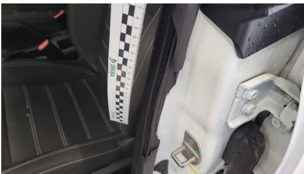
Fot. 70. Uszczelka drzwi przednich L - Pęknięcie/rozerwanie 1
