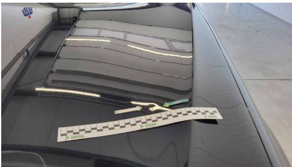
Fot. 46. Pokrywa komory silnika - Wgniecenie/odkształcenie 1
