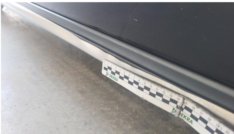
Fot. 52. Próg P - Wgniecenie/odkształcenie 1
