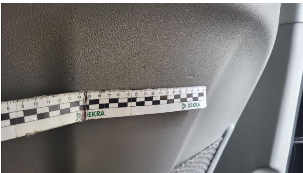
Fot. 74. Fotel prz. praw. - Wgniecenie/odkształcenie 1
