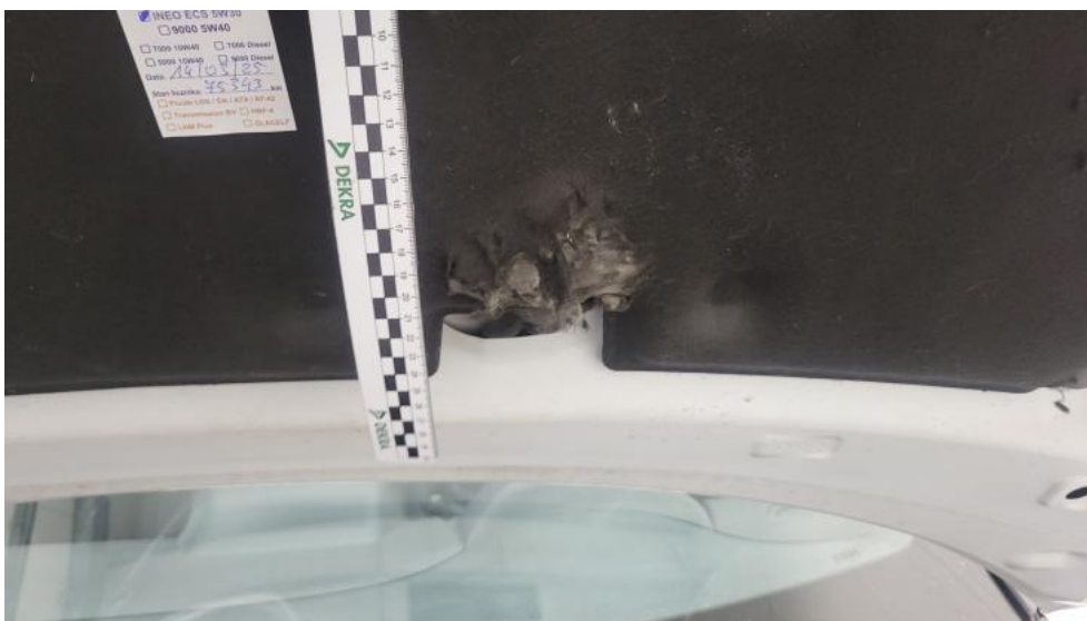
Fot. 38. Wykładzina pokrywy komory silnika - Pęknięcie/rozerwanie 1
