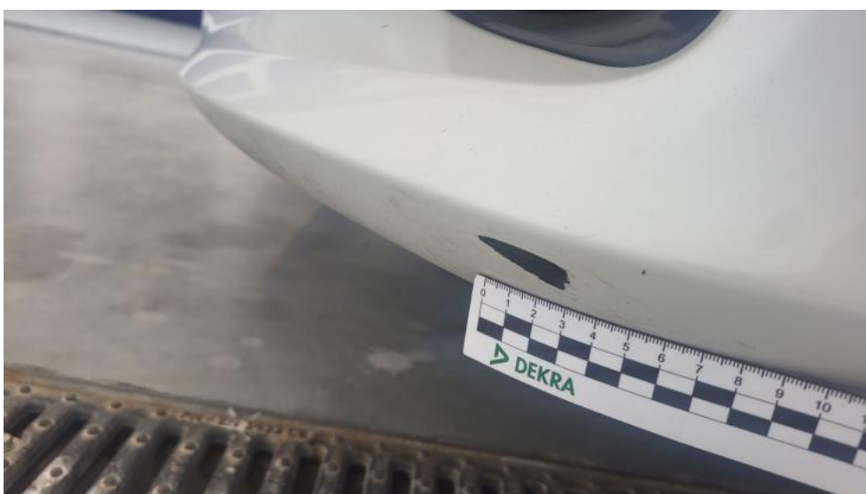
Fot. 40. Zderzak - Rysa/odprysk 2
