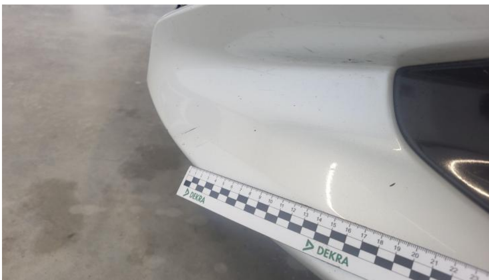
Fot. 39. Zderzak - Rysa/odprysk 1
