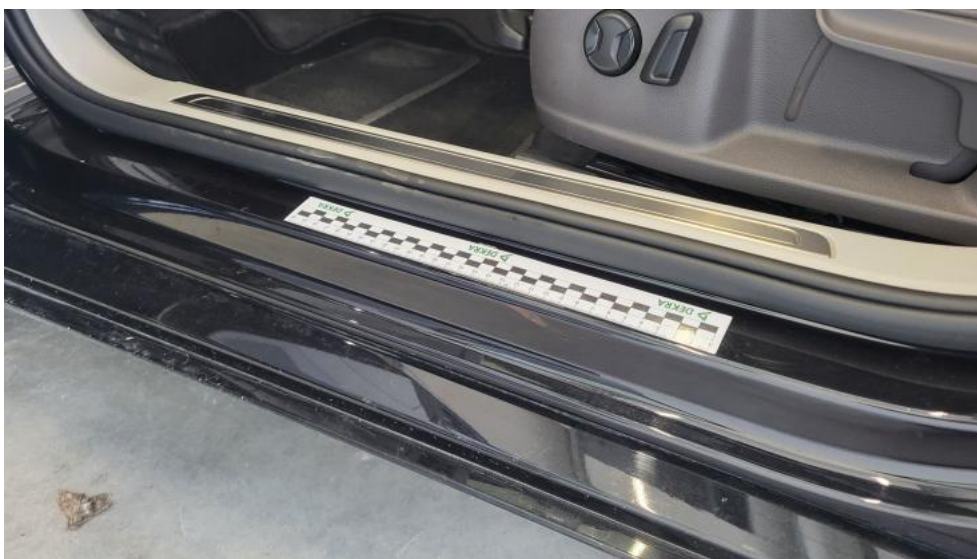
Fot. 51. Próg L - Rysa/odprysk 1
