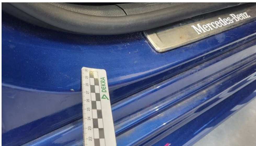
Fot. 57. Próg P - Rysa/odprysk 1
