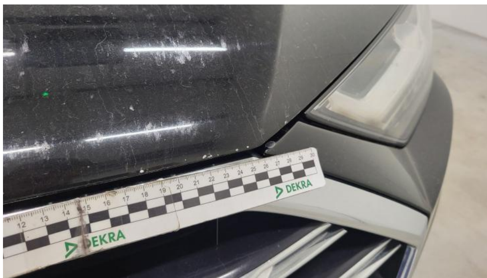
Photo 53. Pokrywa komory silnika - Rysa/odprysk 2
