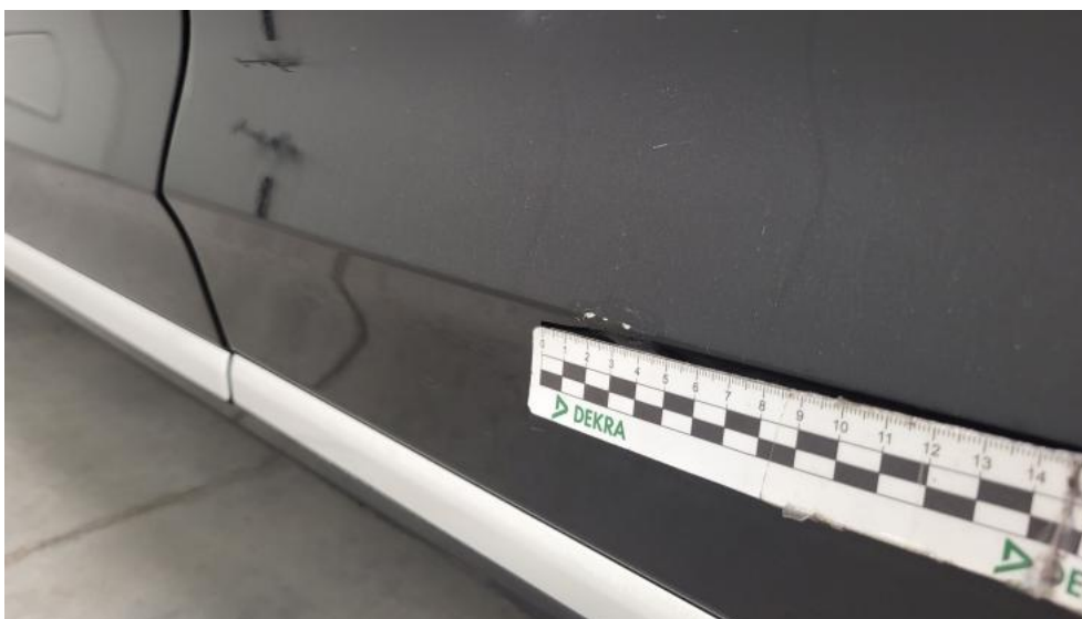
Photo 79. Drzwi tylne L - Rysa/odprysk 2
