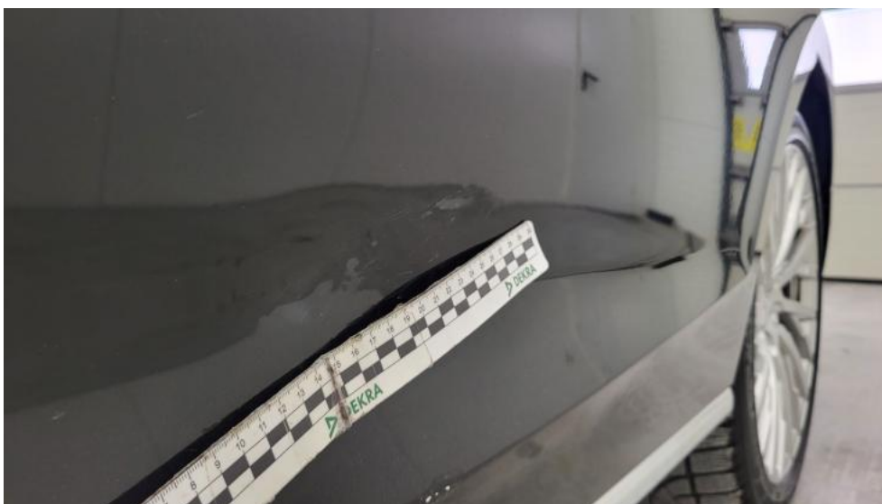
Photo 80. Drzwi tylne L - Wgniecenie/odkształcenie 1
