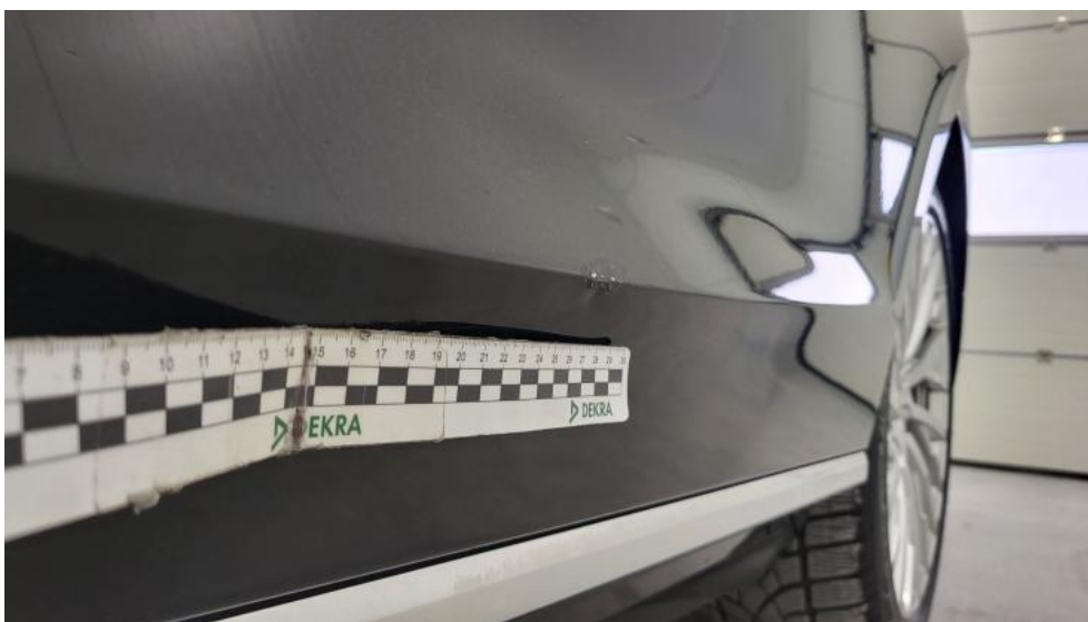
Photo 81. Drzwi tylne L - Wgniecenie/odkształcenie 2
