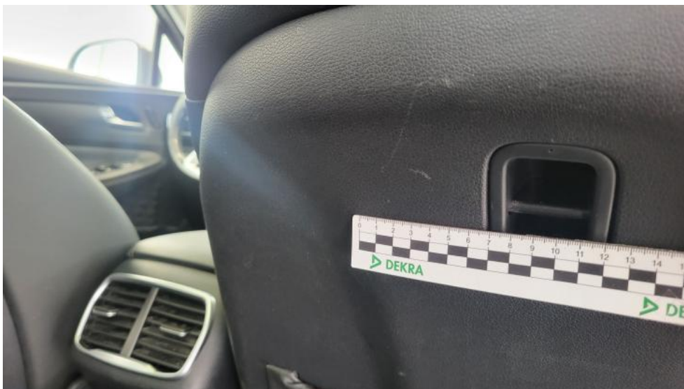
Fot. 88. Fotel prz. praw. - Rysa/odprysk 1
