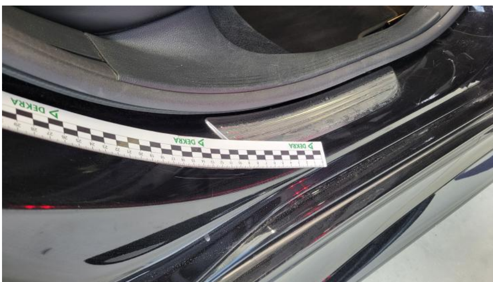
Fot. 52. Próg P - Rysa/odprysk 2
