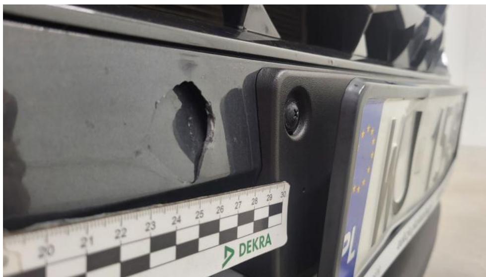
Fot. 43. Zderzak - Wgniecenie/odkształcenie 2
