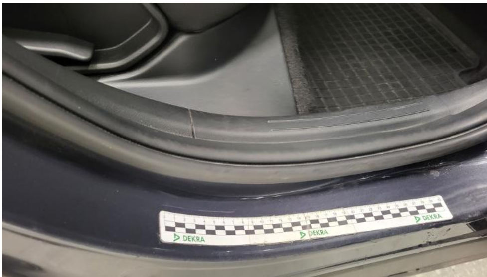
Fot. 57. Próg P - Rysa/odprysk 1
