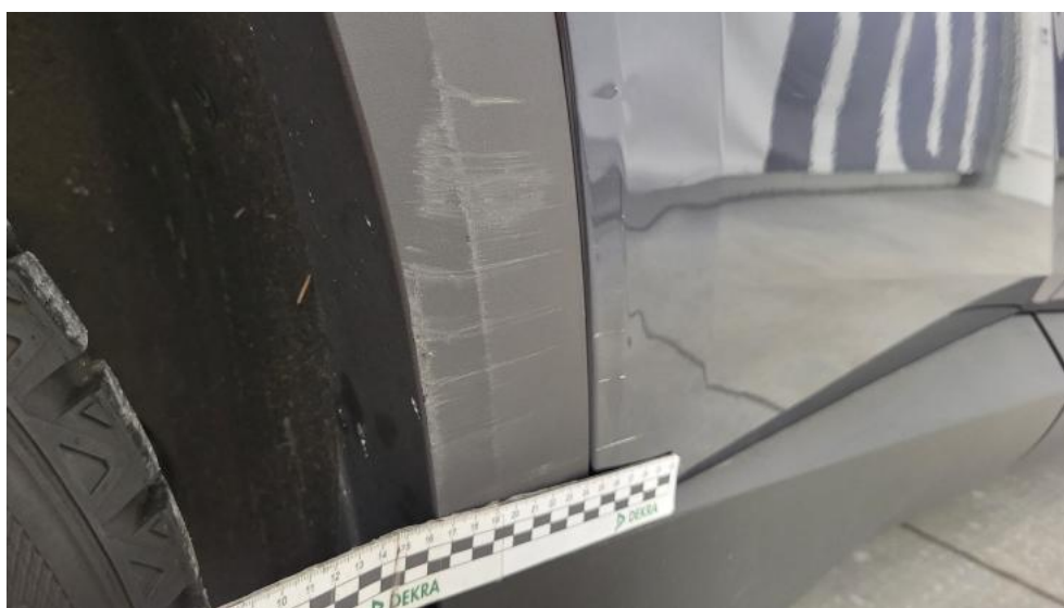
Fot. 52. Drzwi tylne P - Rysa/odprysk 1
