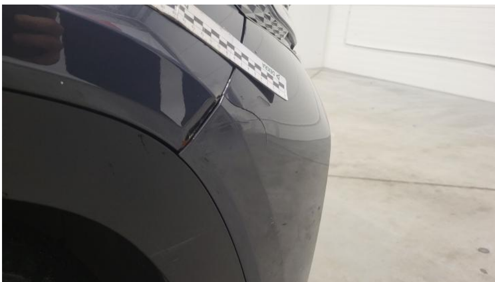
Fot. 46. Zderzak - Pęknięcie/rozerwanie 2
