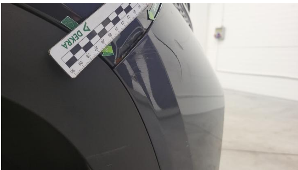
Fot. 48. Błotnik przedni P - Wgniecenie/odkształcenie 1
