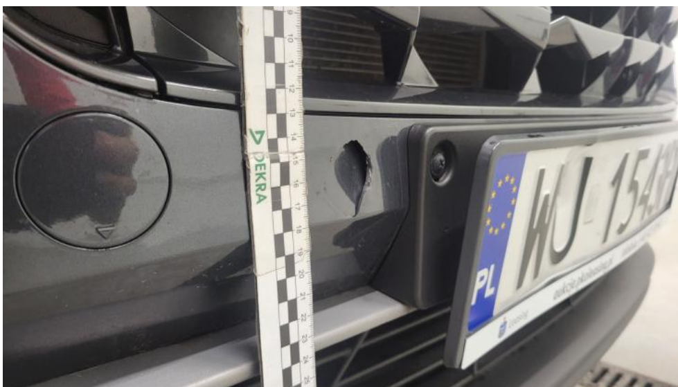
Fot. 45. Zderzak - Pęknięcie/rozerwanie 1
