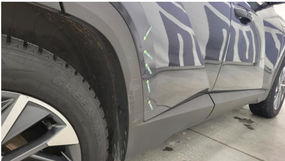
Fot. 55. Drzwi tylne P() - Wgniecenie/odkształcenie 3
