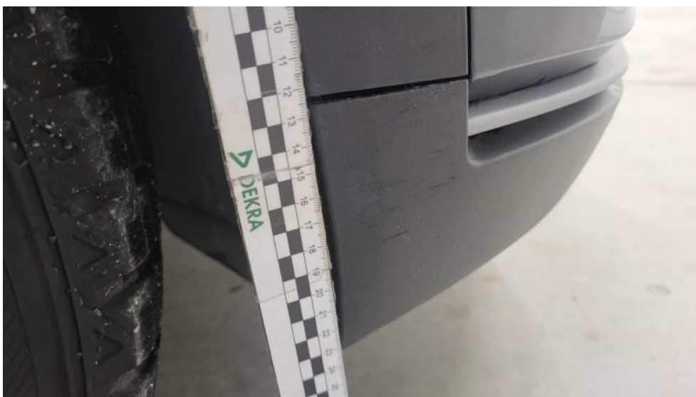
Fot. 40. Zderzak - Rysa/odprysk 2
