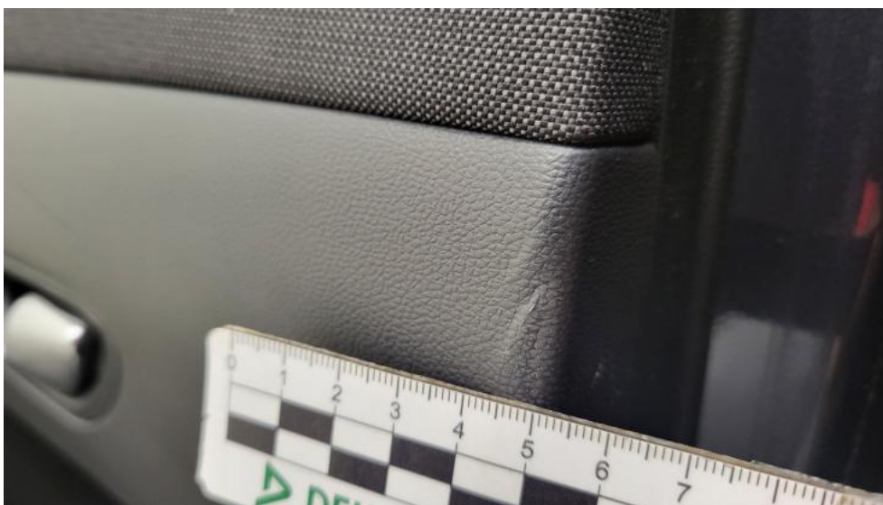
Fot. 67. Tapicerka drzwi tylnych L - Rysa/odprysk 1
