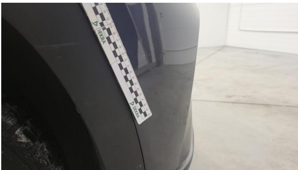
Fot. 39. Zderzak - Rysa/odprysk 1
