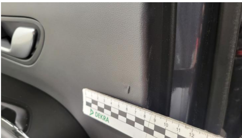
Fot. 68. Tapicerka drzwi tylnych L - Wgniecenie/odkształcenie 1
