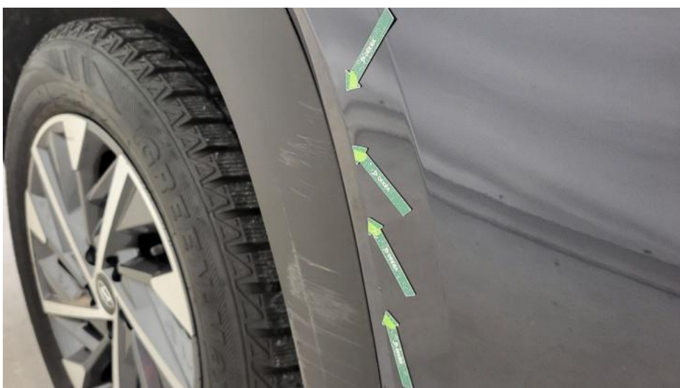
Fot. 54. Drzwi tylne P - Wgniecenie/odkształcenie 2
