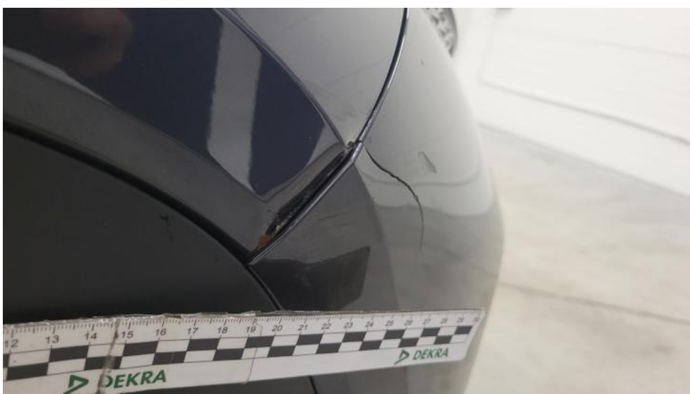
Fot. 42. Zderzak - Wgniecenie/odkształcenie 1
