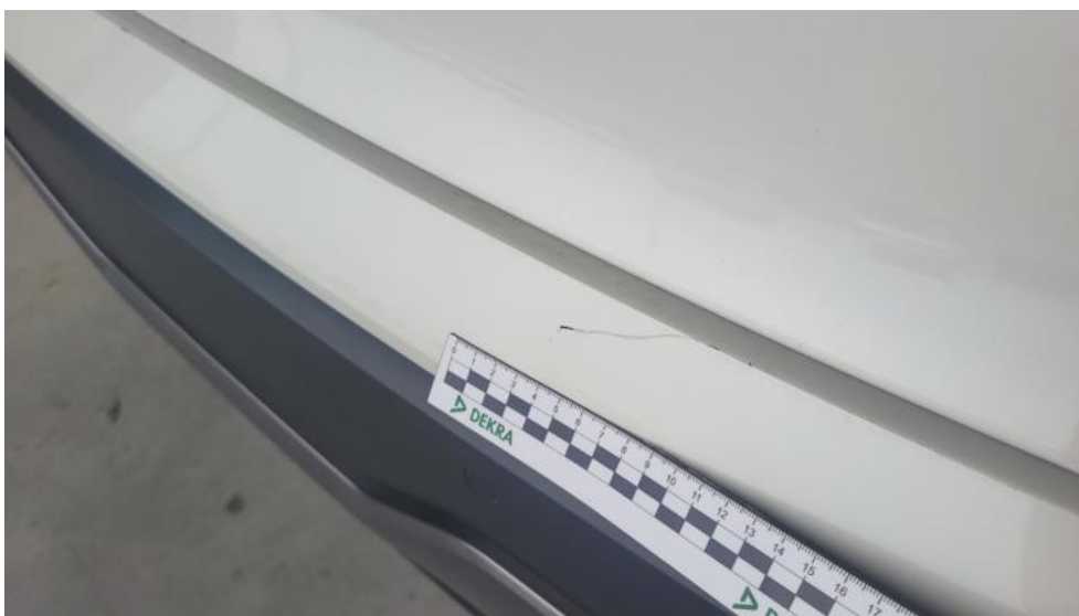
Photo 42. Zderzak tylny - Rysa/odprysk 1
