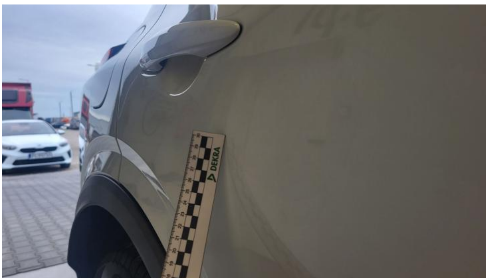
Photo 40. Drzwi tylne P - Wgniecenie/odkształcenie 1
