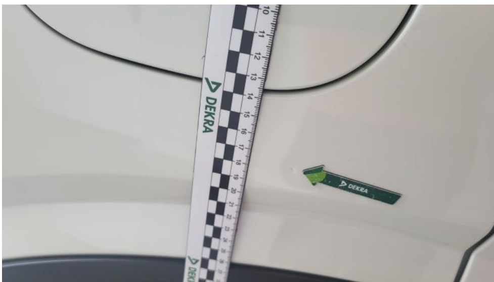
Photo 41. Błotnik tylny P / Ściana boczna P - Wgniecenie/odkształcenie 1
