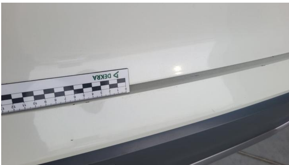
Photo 44. Zderzak tylny() - Rysa/odprysk 3
