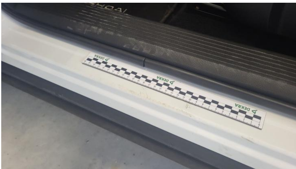
Photo 47. Próg L - Rysa/odprysk 1
