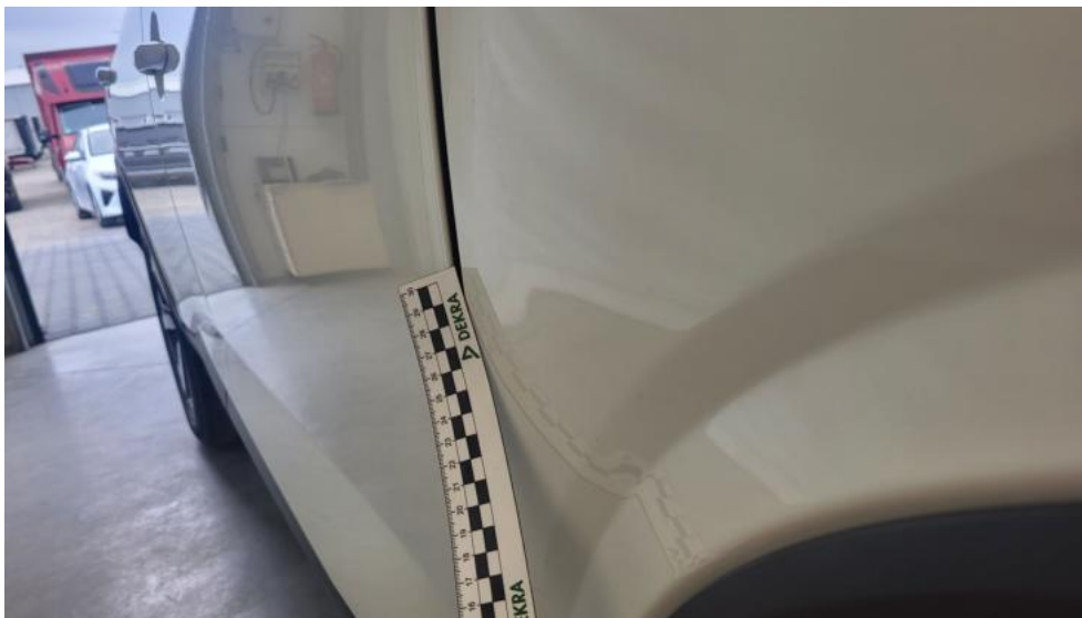
Photo 39. Błotnik przedni P - Wgniecenie/odkształcenie 2
