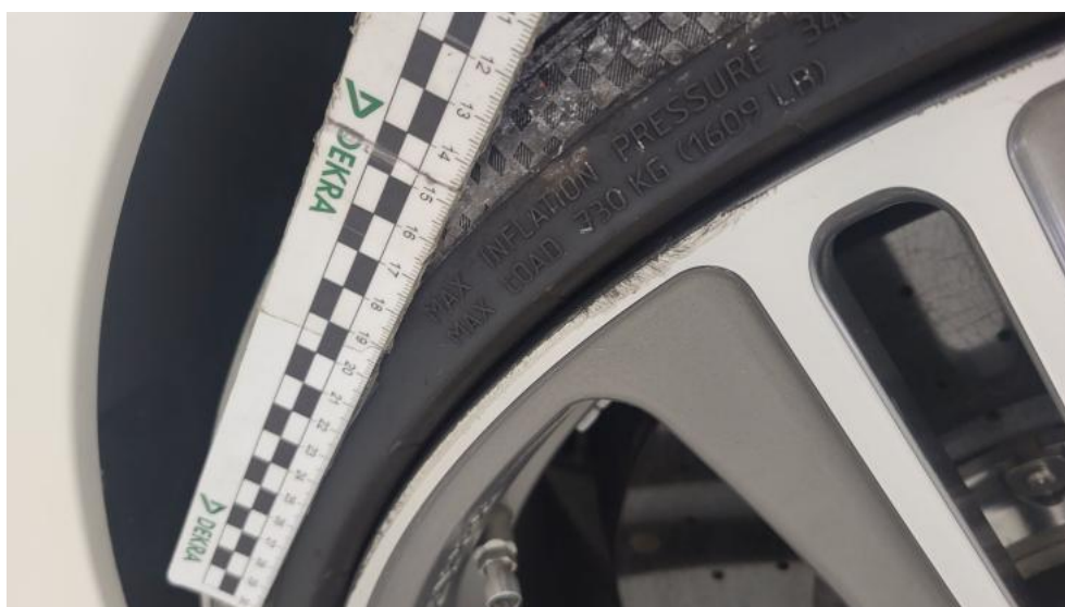
Photo 72. Felga Aluminiowa przednia L - Rysa/odprysk 2
