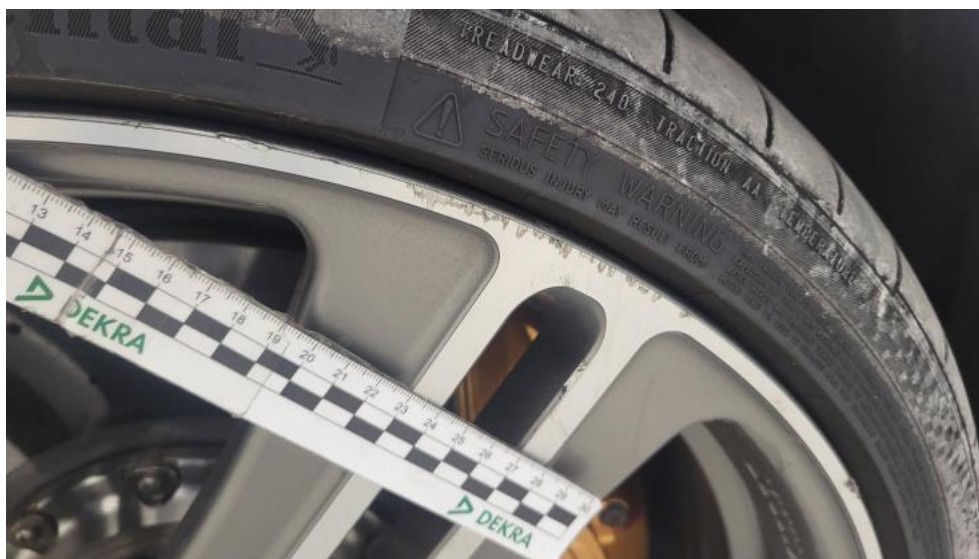
Photo 71. Felga Aluminiowa przednia L - Rysa/odprysk 1
