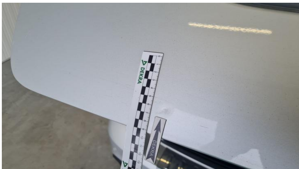
Fot. 48. Pokrywy bagażnika - Wgniecenie/odkształcenie 1
