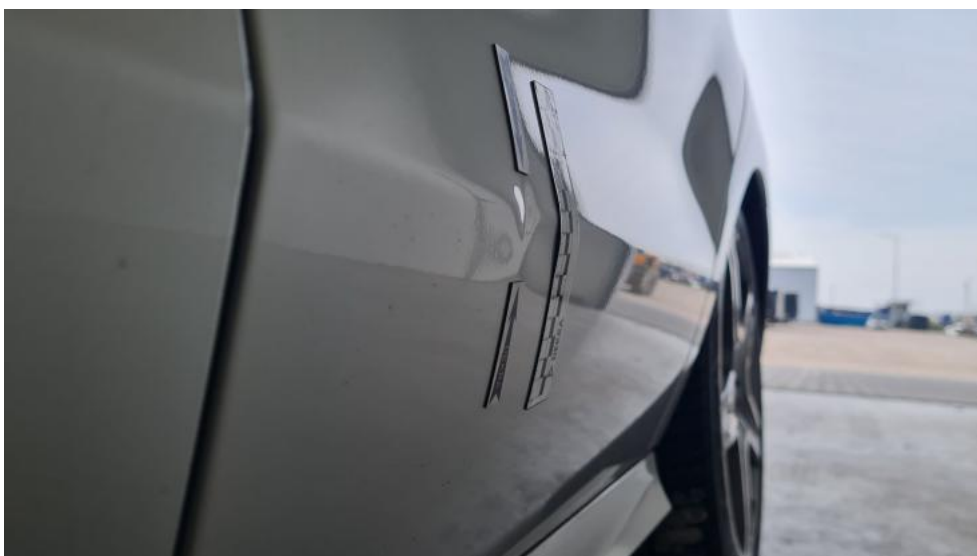
Fot. 56. Drzwi tylne L - Wgniecenie/odkształcenie 2
