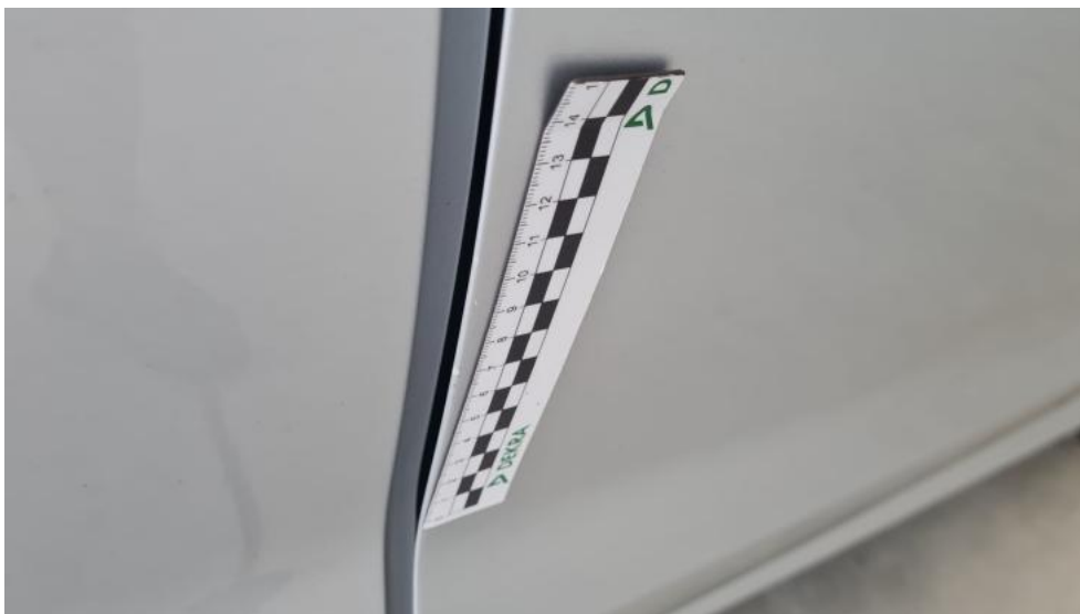
Fot. 39. Drzwi przednie P - Rysa/odprysk 1
