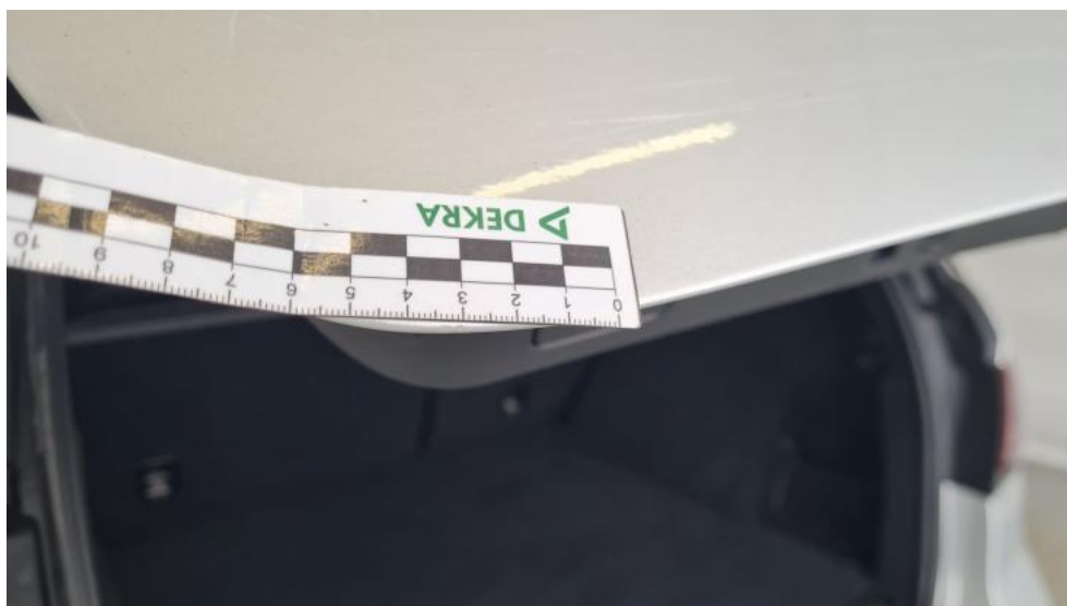
Fot. 46. Pokrywy bagażnika - Rysa/odprysk 1
