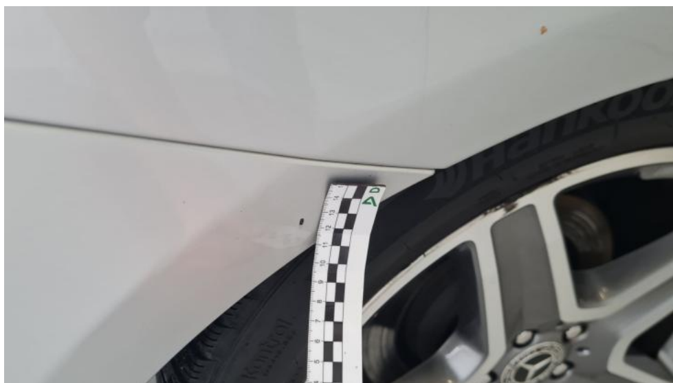
Fot. 50. Zderzak tylny - Rysa/odprysk 1
