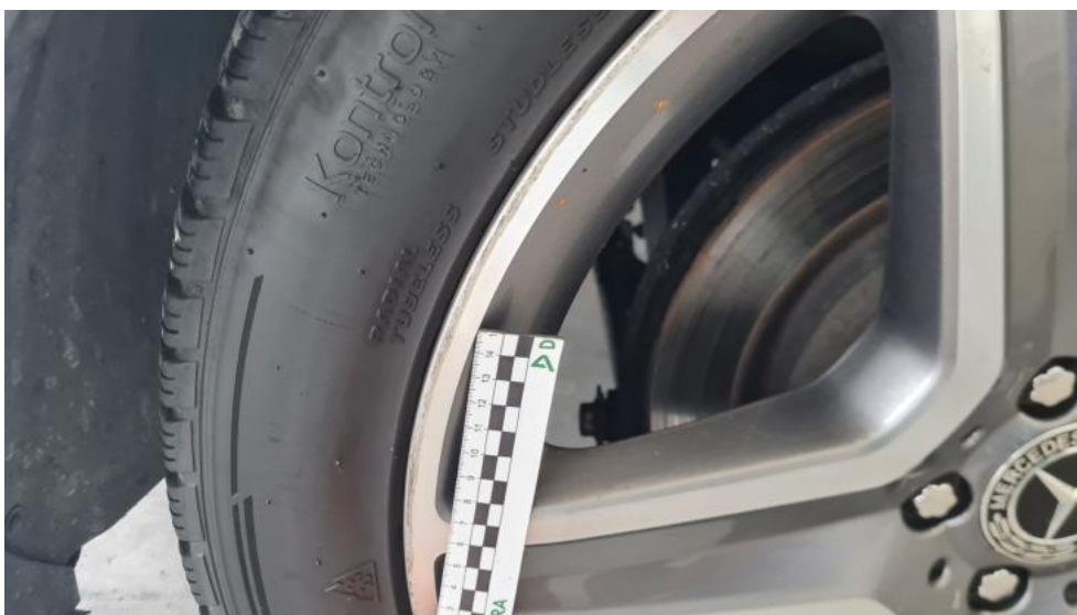
Fot. 44. Felga aluminiowa tylna P - Rysa/odprysk 1
