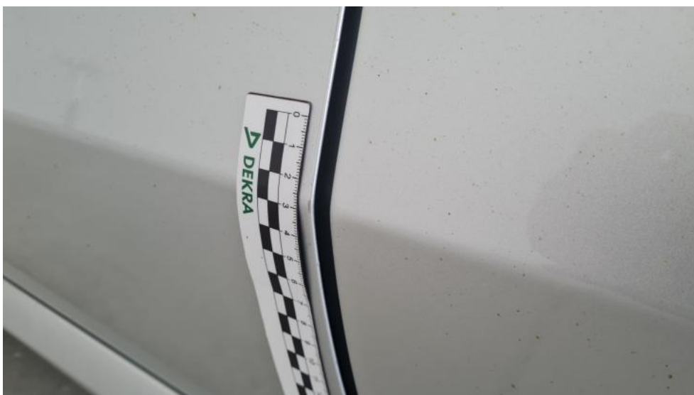
Fot. 54. Drzwi przed L - Rysa/odprysk 1
