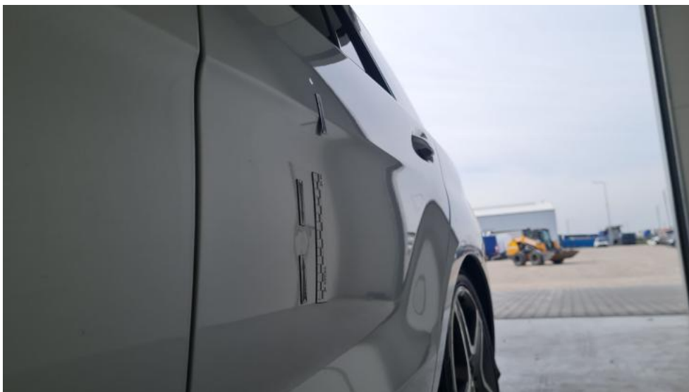
Fot. 55. Drzwi tylne L - Wgniecenie/odkształcenie 1
