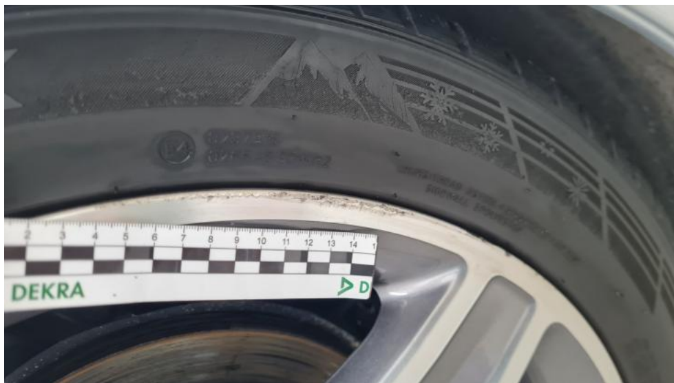
Fot. 45. Felga aluminiowa tylna P - Rysa/odprysk 2
