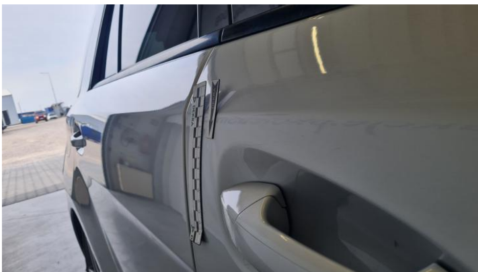
Fot. 40. Drzwi przednie P - Wgniecenie/odkształcenie 1
