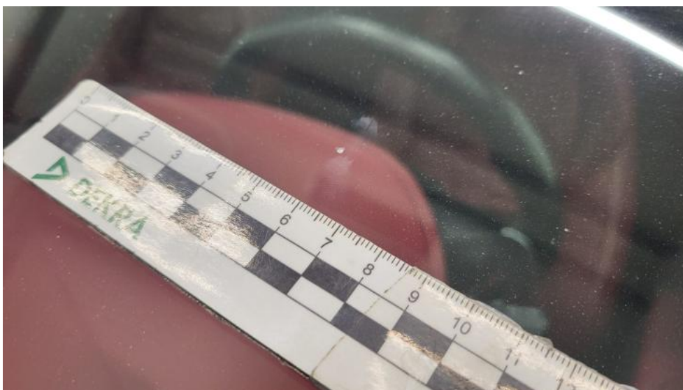
Photo 52. Szyba czołowa - Rysa/odprysk 1
