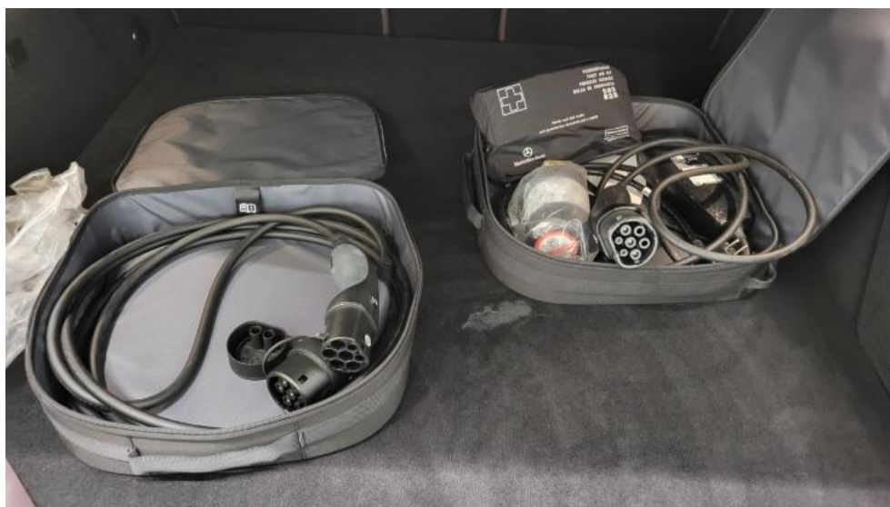
Fot. 36. Przewód ładowania baterii trakcyjnej
