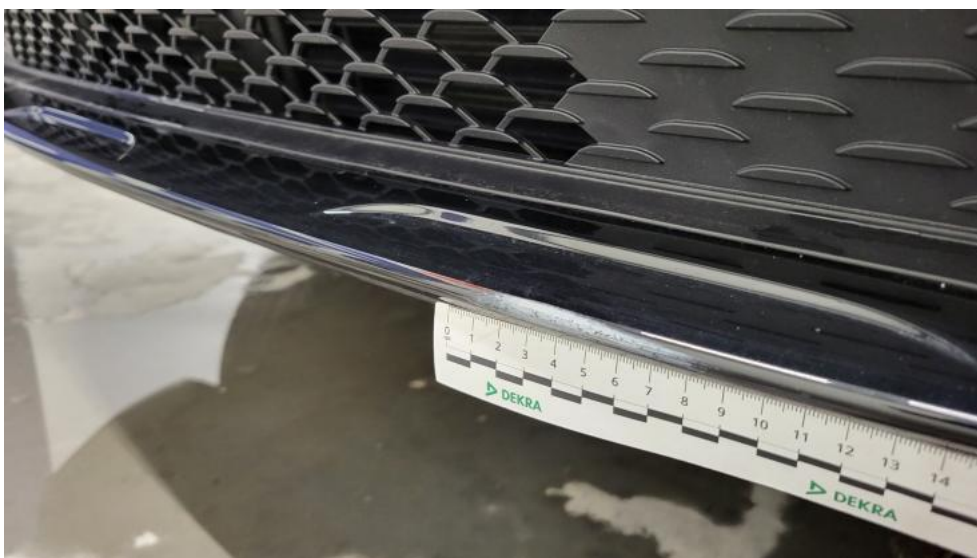
Fot. 48. Spoiler zderzaka przedniego - Rysa/odprysk 1
