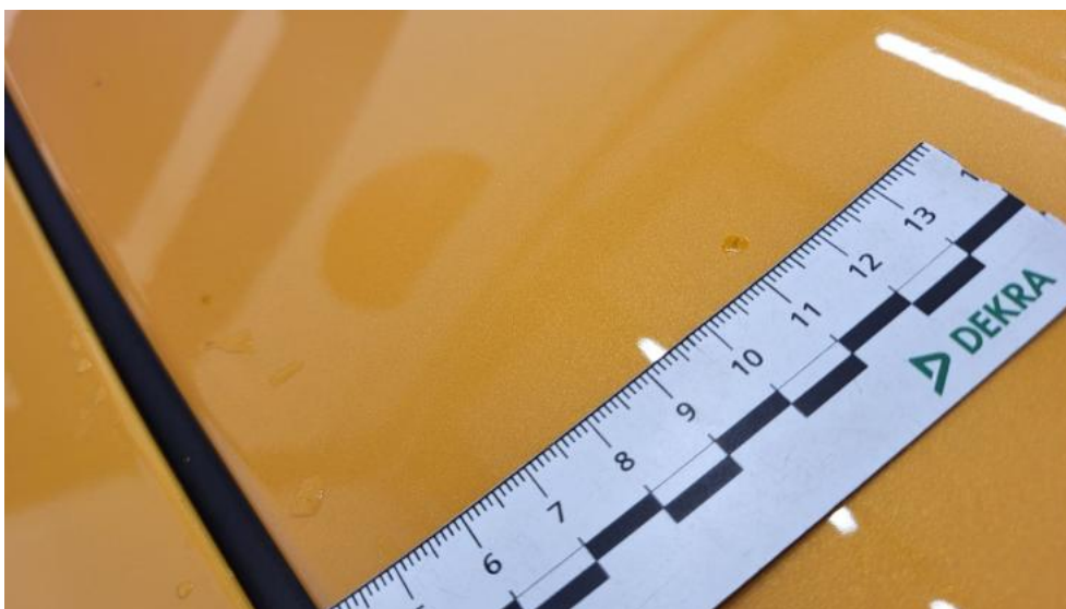
Fot. 38. Pokrywa komory silnika - Rysa/odprysk 1
