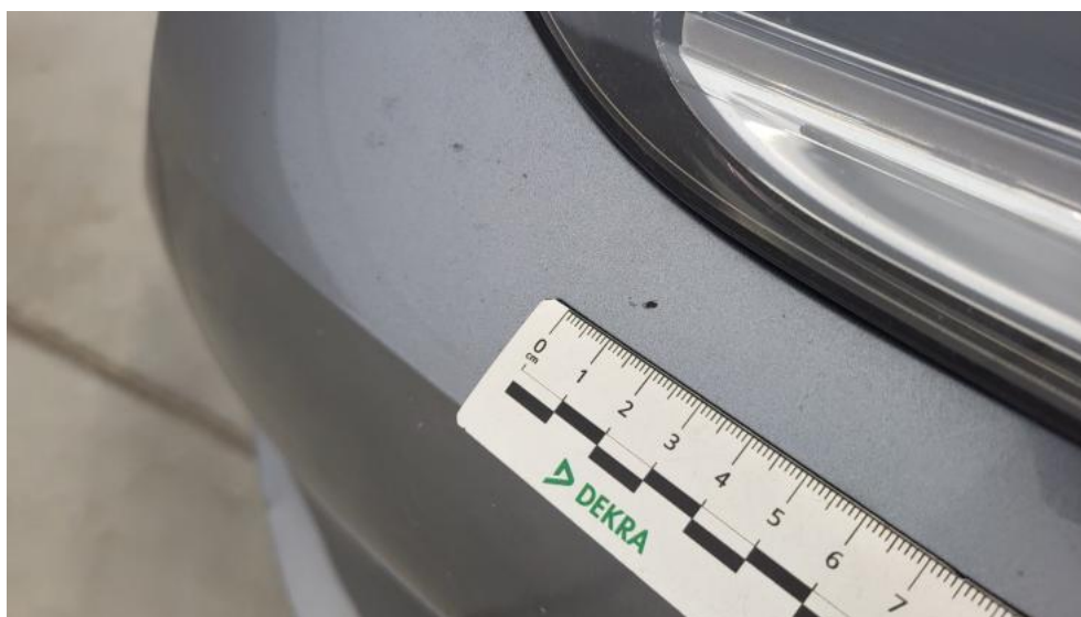
Fot. 41. Zderzak - Rysa/odprysk 1
