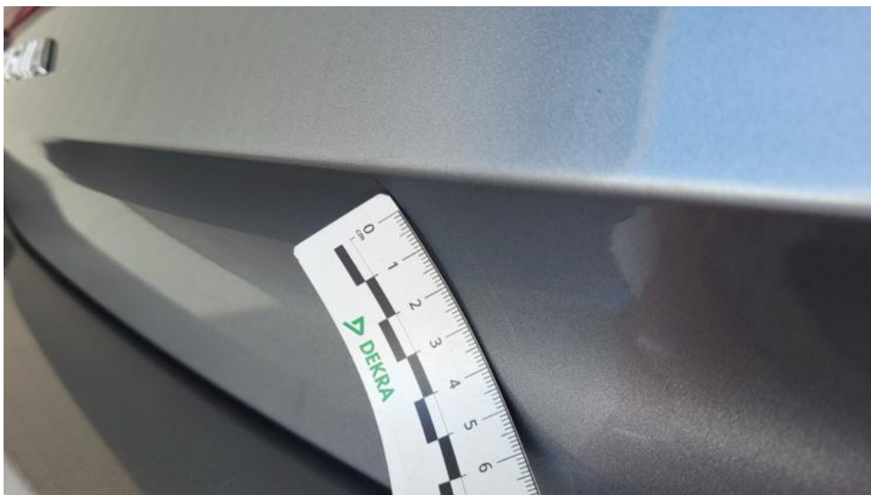
Fot. 51. Pokrywy bagażnika - Rysa/odprysk 1
