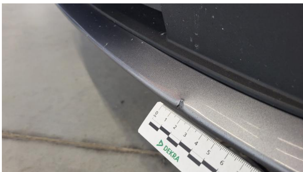
Fot. 42. Zderzak - Wgniecenie/odkształcenie 1
