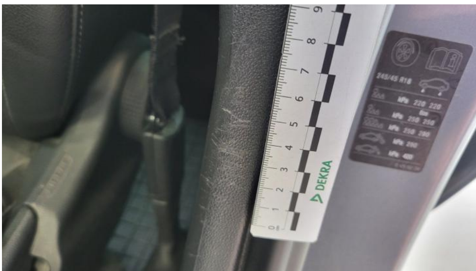
Fot. 72. Wykładzina(y) słupka środkowego L - Rysa/odprysk 1
