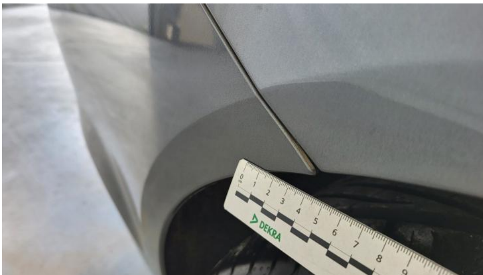
Fot. 55. Zderzak tylny - Wgniecenie/odkształcenie 1
