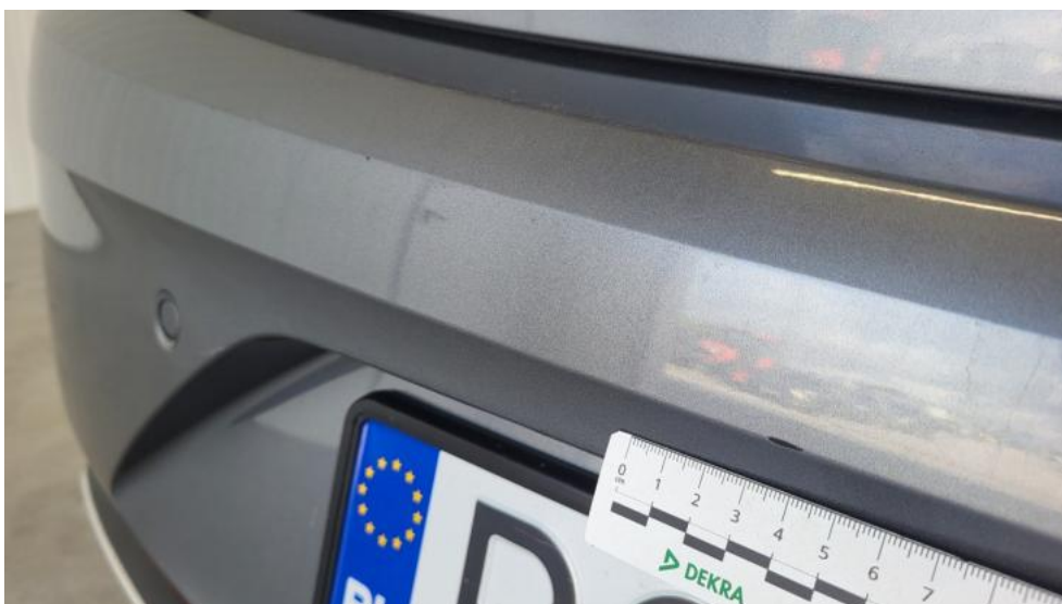
Fot. 54. Zderzak tylny - Rysa/odprysk 2
