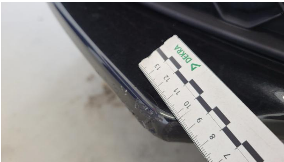
Fot. 48. Zderzak - Pęknięcie/rozerwanie 1
