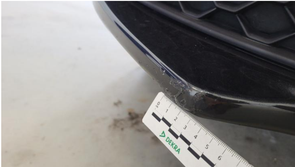
Fot. 47. Zderzak - Wgniecenie/odkształcenie 1
