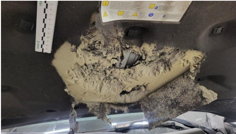
Fot. 45. Wykładzina pokrywy komory silnika - Pęknięcie/rozerwanie 1
