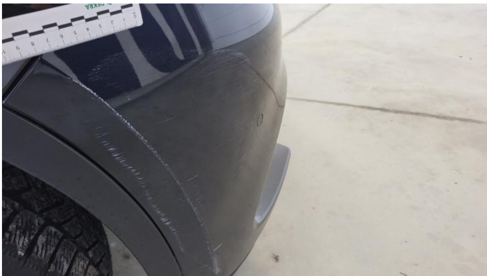
Fot. 46. Zderzak - Rysa/odprysk 1
