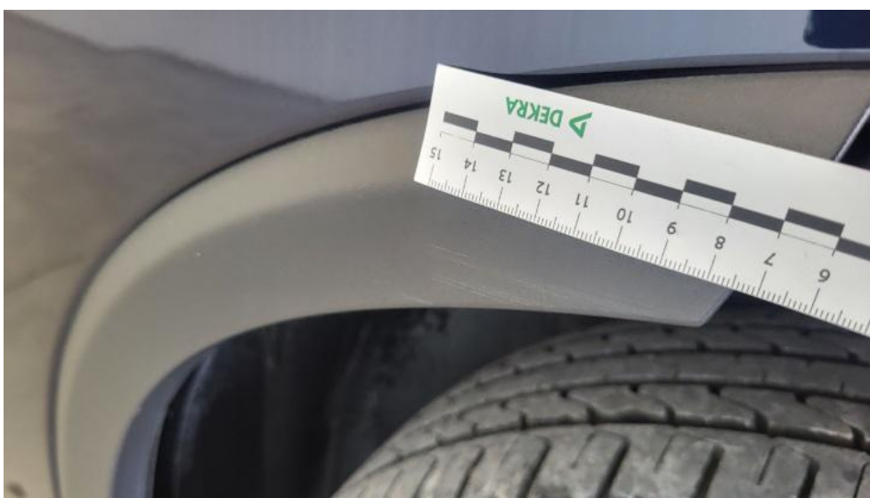
Fot. 82. Listwa drzwi tylnych L - Rysa/odprysk 1
