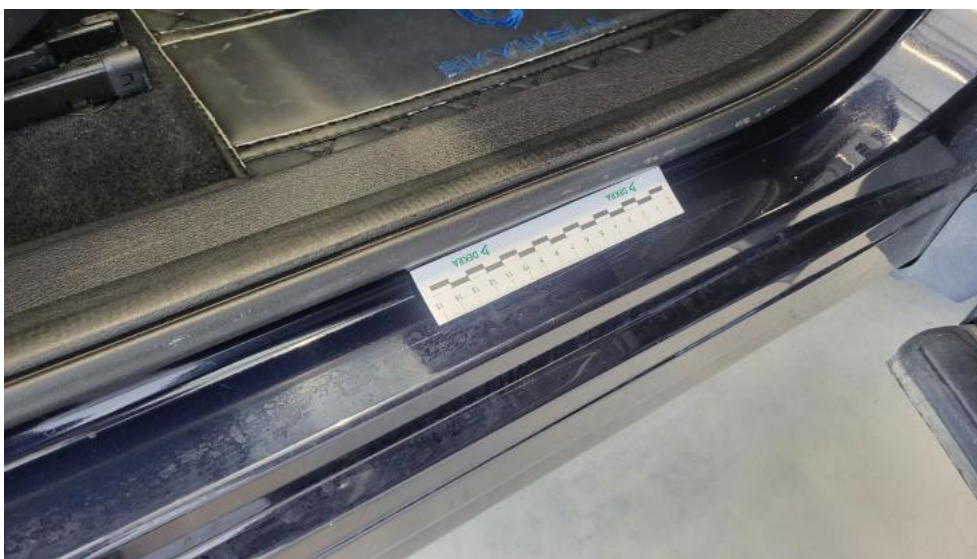
Fot. 59. Próg P - Rysa/odprysk 1
