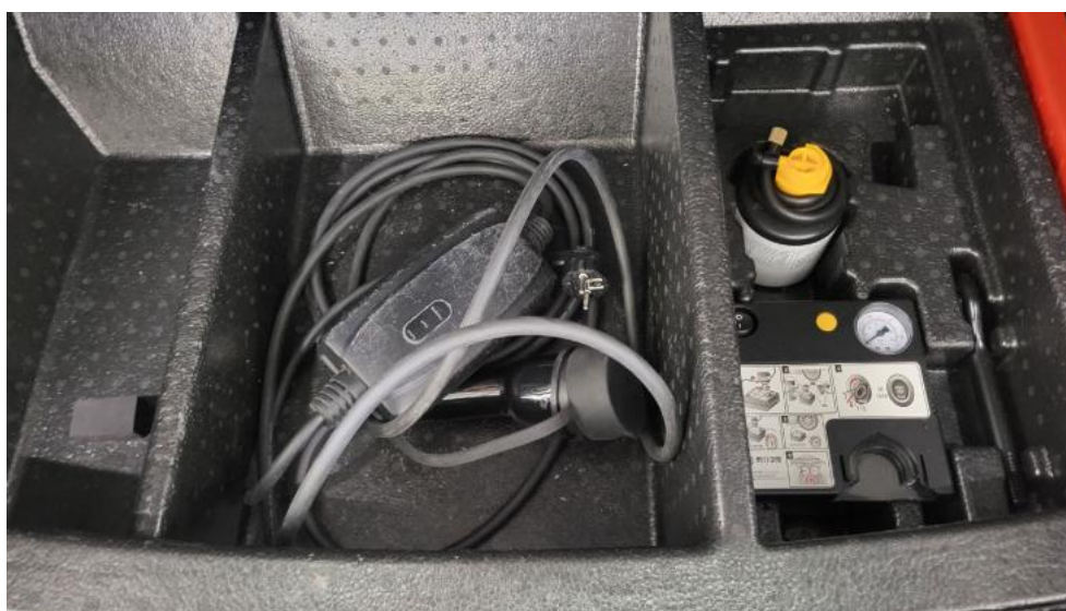
Fot. 34. Przewód ładowania baterii trakcyjnej
