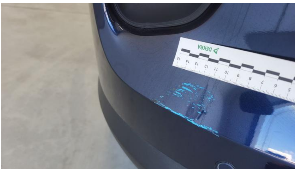
Fot. 64. Zderzak tylny cz L - Rysa/odprysk 1
