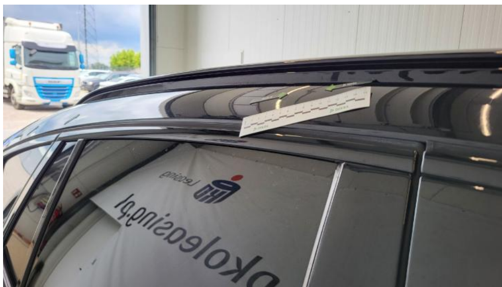
Photo 49. Błotnik tylny P / Ściana boczna P - Wgniecenie/odkształcenie 1
