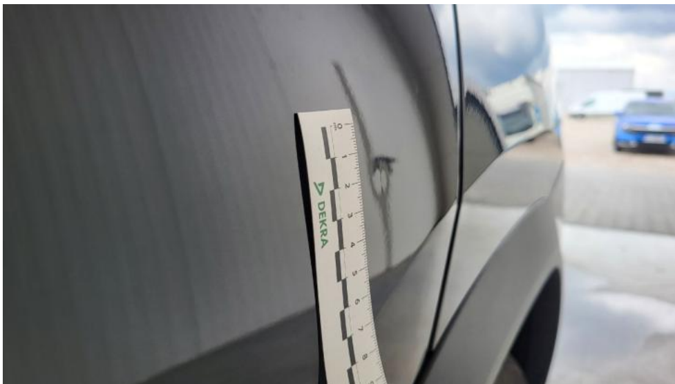
Photo 59. Drzwi tylne L - Wgniecenie/odkształcenie 1
