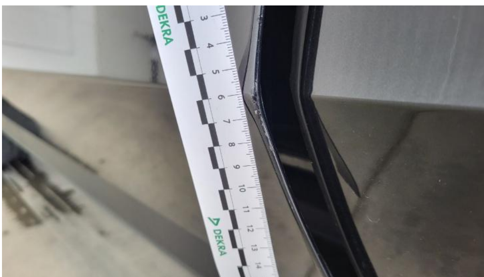
Photo 56. Drzwi przed L - Rysa/odprysk 1
