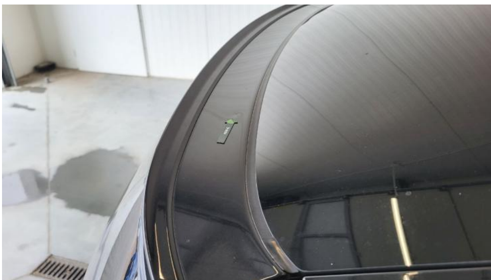
Photo 54. Pokrywy bagażnika - Wgniecenie/odkształcenie 2
