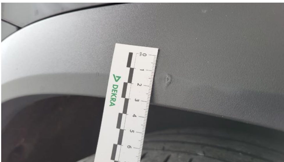
Photo 52. Listwa krawędzi błotnika tył P - Rysa/odprysk 1
