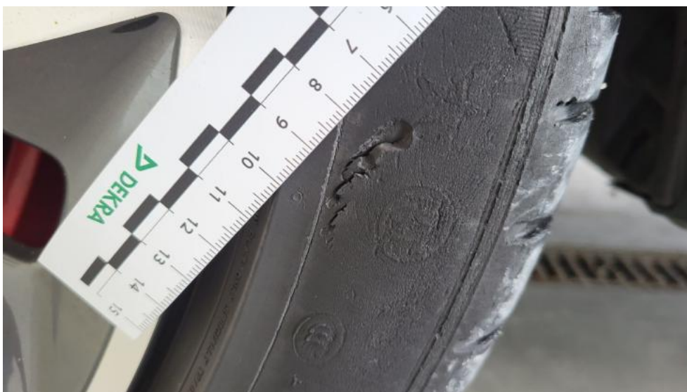
Photo 60. Opona przednia L - Pęknięcie/rozerwanie 1
