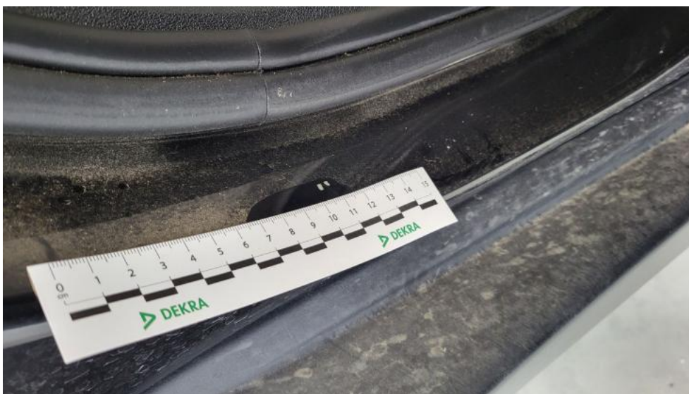
Photo 47. Próg P - Rysa/odprysk 1
