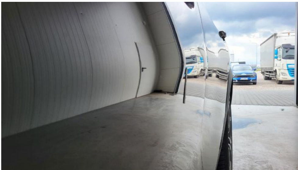
Photo 57. Drzwi przed L - Wgniecenie/odkształcenie 1
