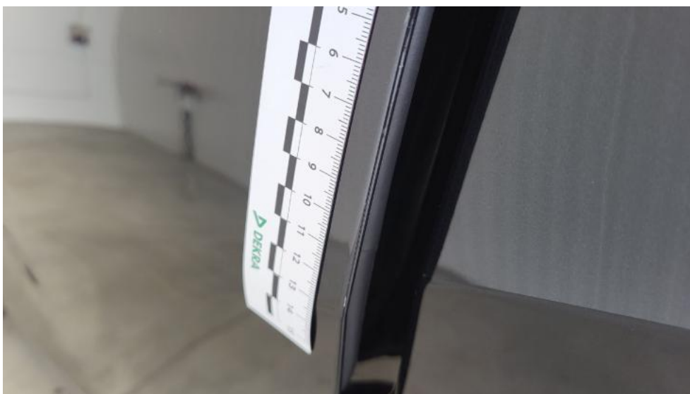
Photo 58. Drzwi tylne L - Rysa/odprysk 1
