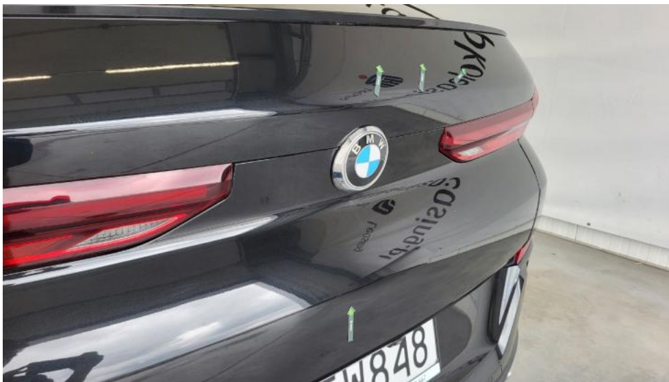
Photo 53. Pokrywy bagażnika - Wgniecenie/odkształcenie 1
