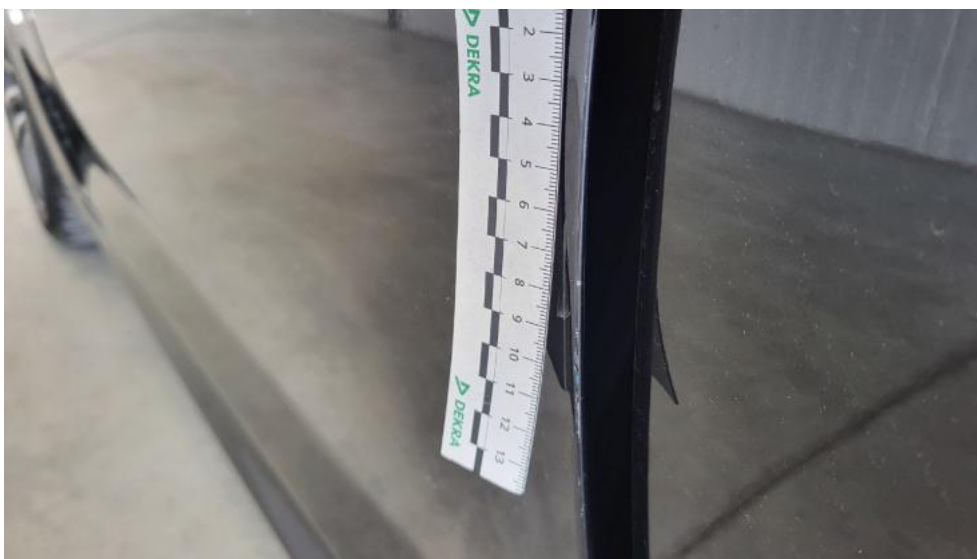
Fot. 53. Drzwi przed L - Rysa/odprysk 1
