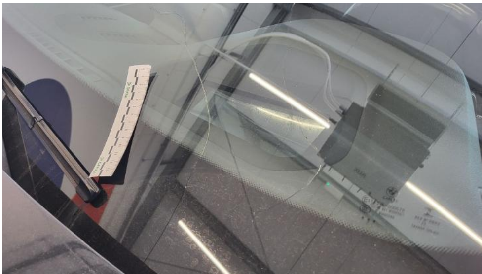
Fot. 43. Szyba czołowa - Pęknięcie/rozerwanie 1
