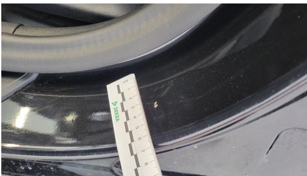
Fot. 54. Próg L - Rysa/odprysk 1
