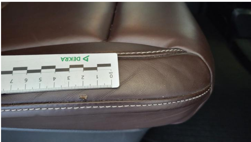
Fot. 75. Kanapa tyl. - Pęknięcie/rozerwanie 1
