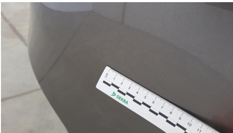
Fot. 48. Zderzak - Rysa/odprysk 1
