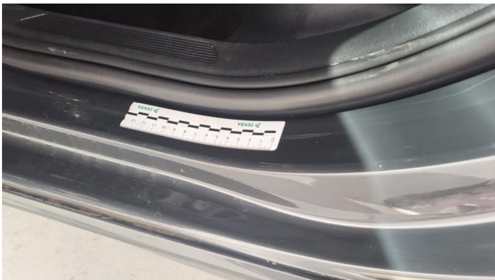
Photo 73. Próg L - Rysa/odprysk 1
