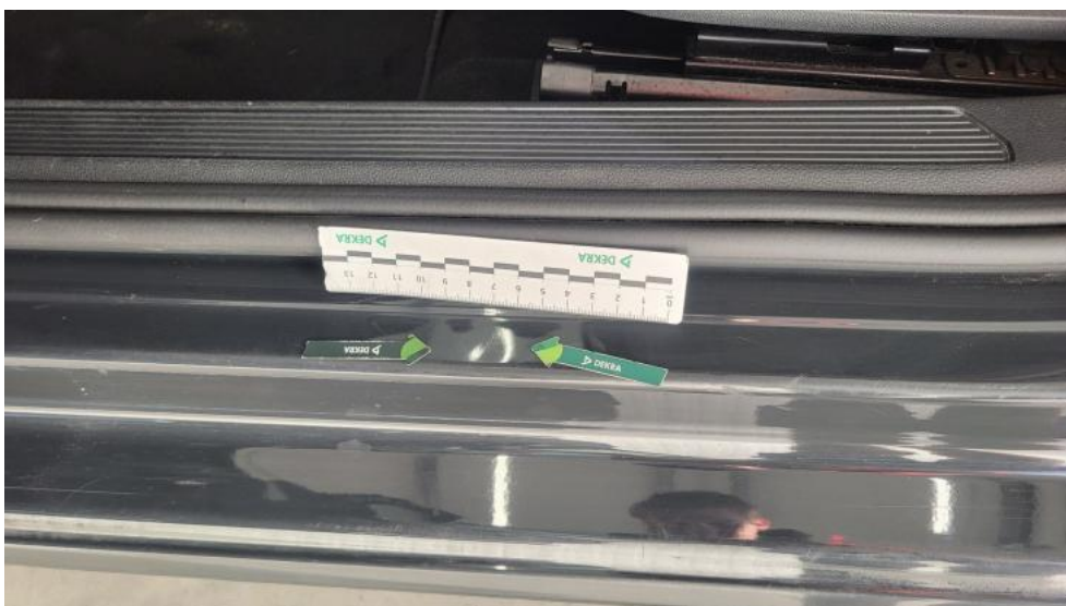
Photo 74. Próg L - Wgniecenie/odkształcenie 1
