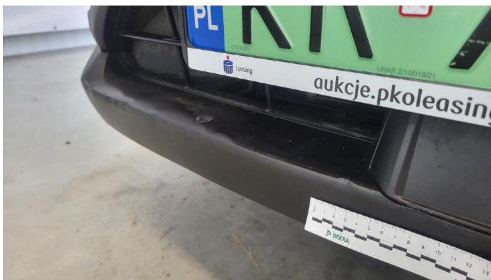
Fot. 46. Spoiler zderzaka przedniego - Wgniecenie/odkształcenie 2
