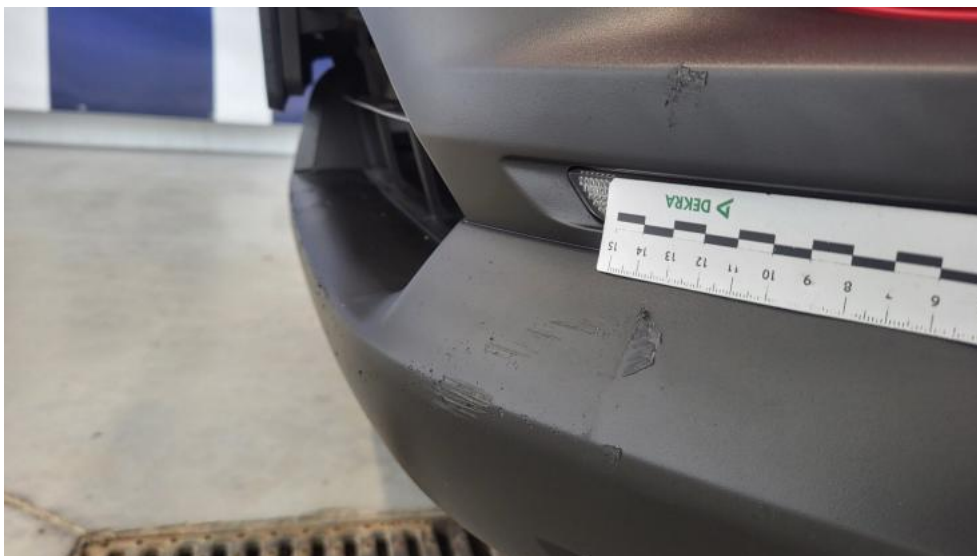
Fot. 45. Spoiler zderzaka przedniego - Wgniecenie/odkształcenie 1
