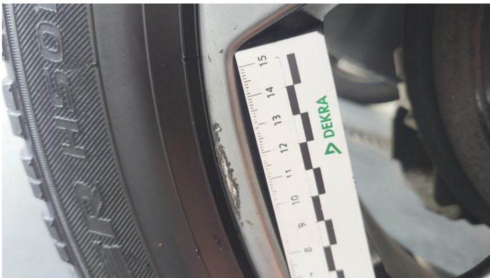
Fot. 72. Felga aluminiowa tylna P - Rysa/odprysk 1
