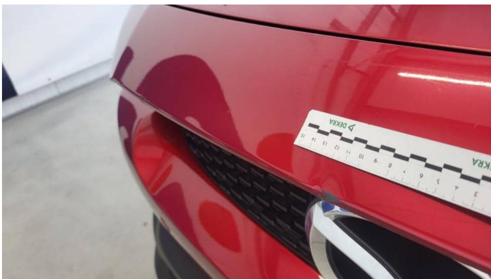
Fot. 54. Zderzak przedni cz górna - Wgniecenie/odkształcenie 1
