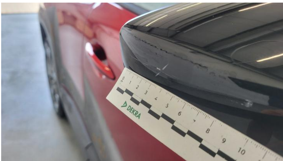
Fot. 68. Lusterko zew P - Rysa/odprysk 1
