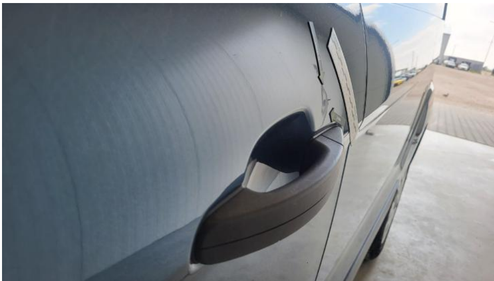
Photo 53. Drzwi przed L - Wgniecenie/odkształcenie 1
