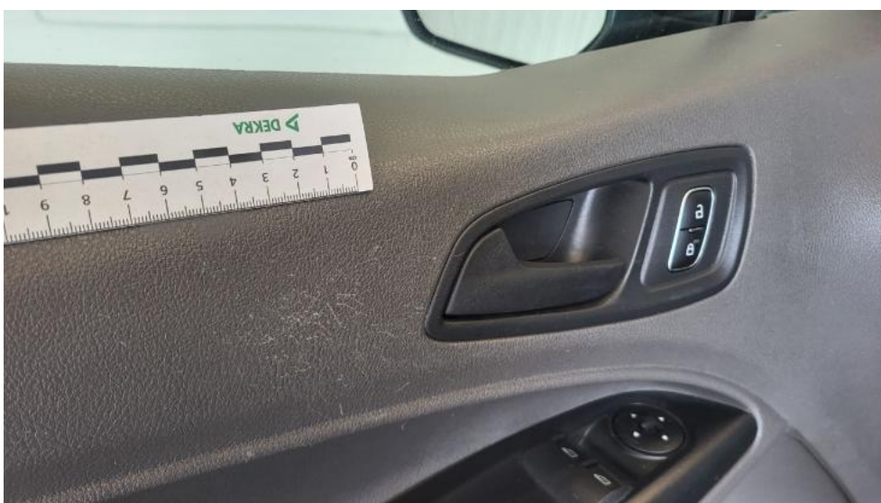
Photo 58. Tapicerka drzwi przednich L - Rysa/odprysk 1
