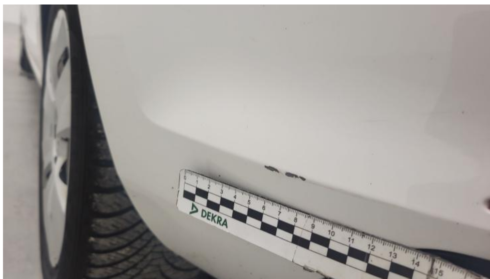
Photo 44. Zderzak tylny - Rysa/odprysk 1
