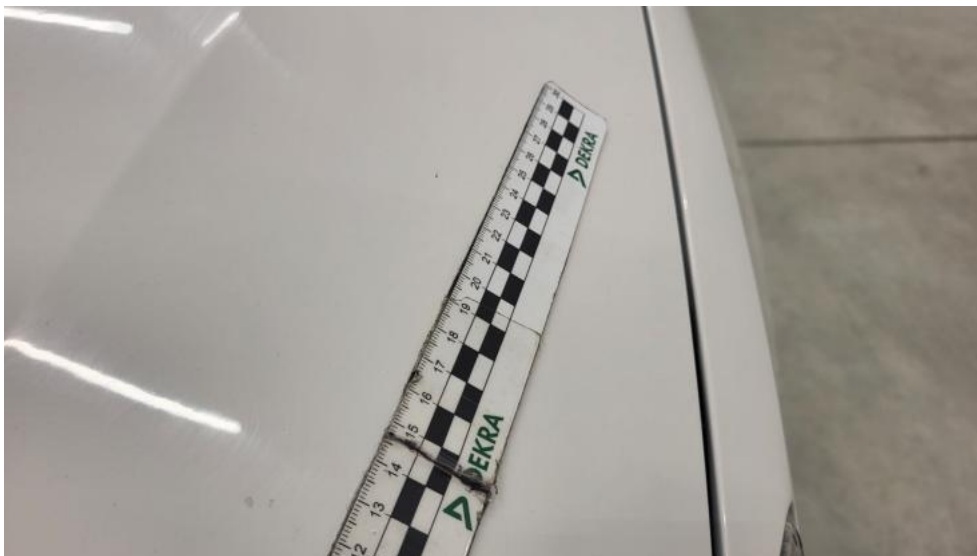
Photo 31. Pokrywa komory silnika - Rysa/odprysk 1
