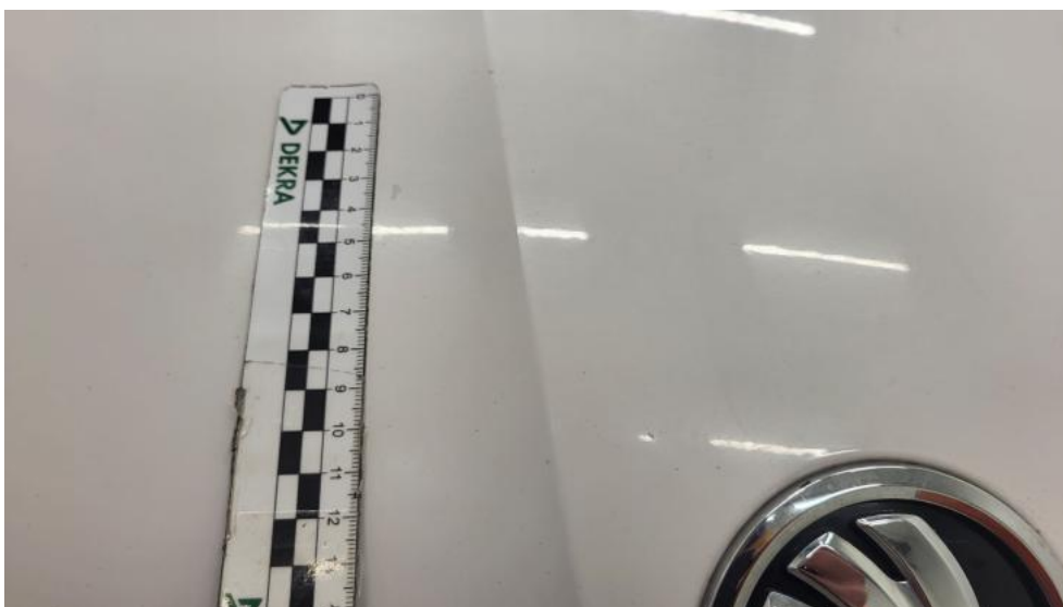
Photo 32. Pokrywa komory silnika - Rysa/odprysk 2
