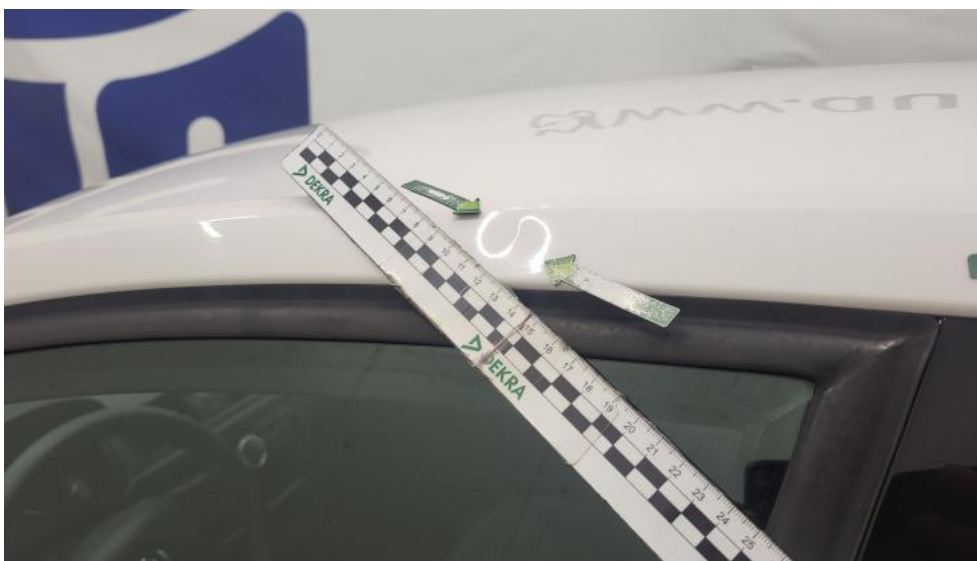
Photo 59. Stupek przedni L - Wgniecenie/odkształcenie 2
