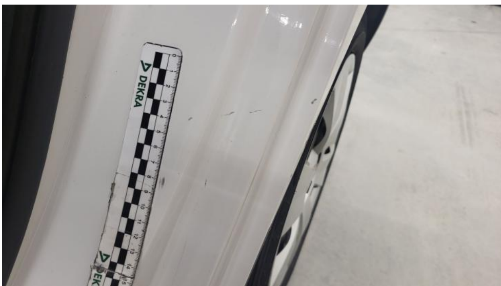
Photo 50. Błotnik tylny L / Ściana boczna L - Rysa/odprysk 2
