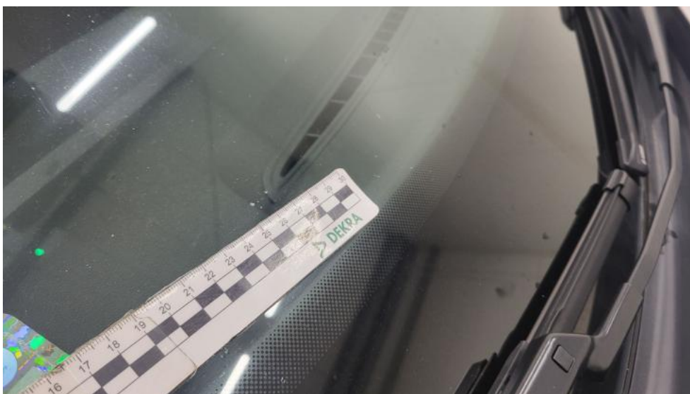
Photo 34. Szyba czołowa - Rysa/odprysk 2
