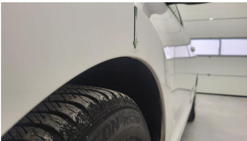
Photo 61. Błotnik przedni L - Wgniecenie/odkształcenie 1
