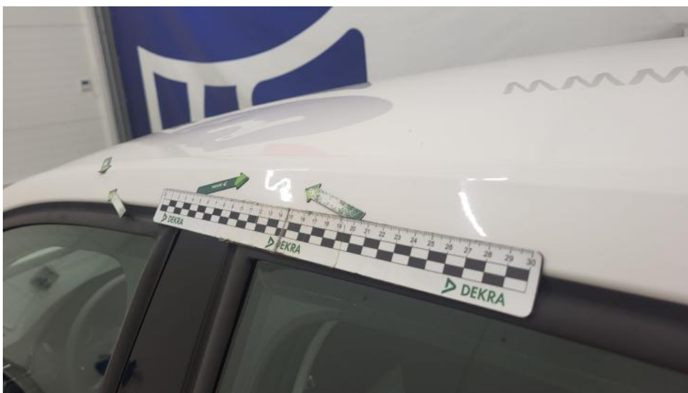
Photo 58. Stupek przedni L - Wgniecenie/odkształcenie 1
