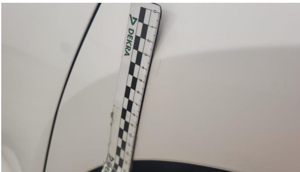
Photo 49. Błotnik tylny L / Ściana boczna L - Rysa/odprysk 1
