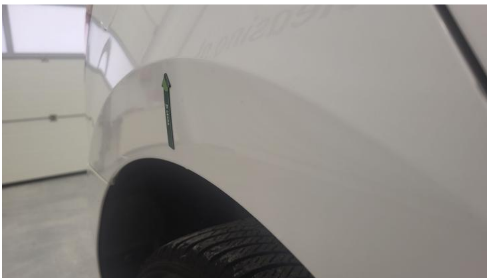
Photo 42. Błotnik tylny P / Ściana boczna P - Wgniecenie/odkształcenie 1
