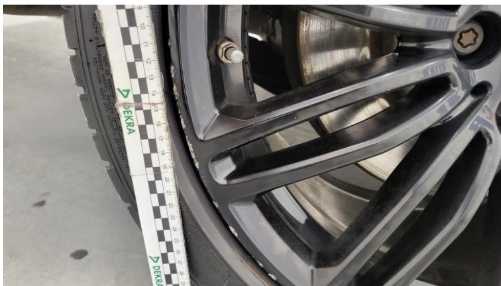
Photo 63. Felga aluminiowa tylna P - Rysa/odprysk 2
