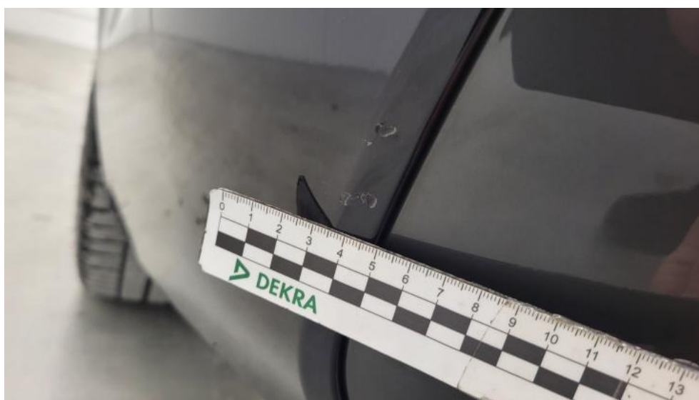
Photo 64. Zderzak tylny - Rysa/odprysk 1
