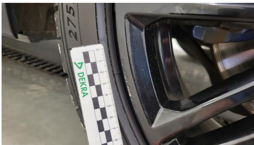
Photo 68. Felga aluminiowa tylna L - Rysa/odprysk 2
