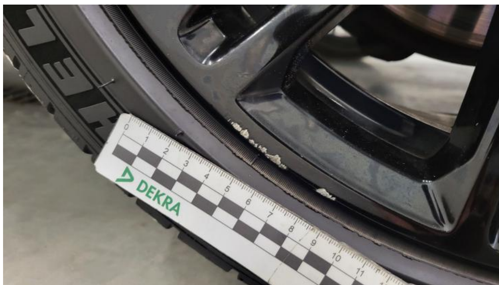
Photo 67. Felga aluminiowa tylna L - Rysa/odprysk 1
