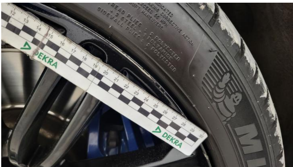
Photo 77. Felga Aluminiowa przednia L - Rysa/odprysk 2
