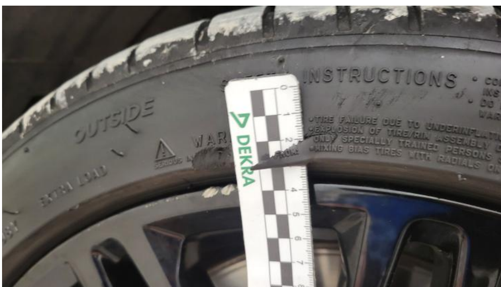
Photo 78. Opona przednia L - Pęknięcie/rozerwanie 1
