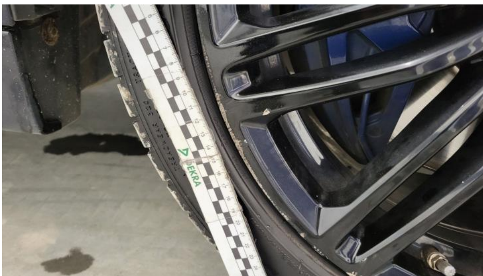
Photo 57. Felga aluminiowa przednia P - Rysa/odprysk 2
