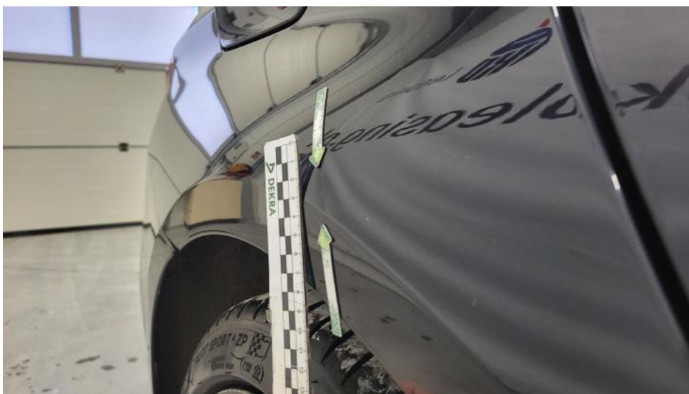
Photo 61. Błotnik tylny P / Ściana boczna P - Wgniecenie/odkształcenie 1
