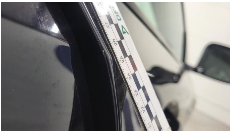
Photo 58. Drzwi przednie P - Rysa/odprysk 1
