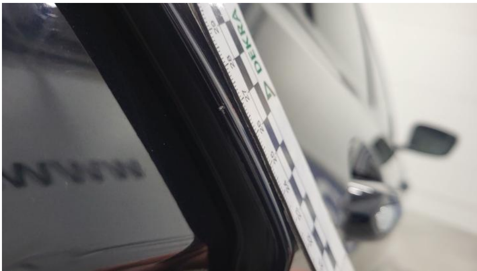
Photo 59. Drzwi tylne P - Rysa/odprysk 1
