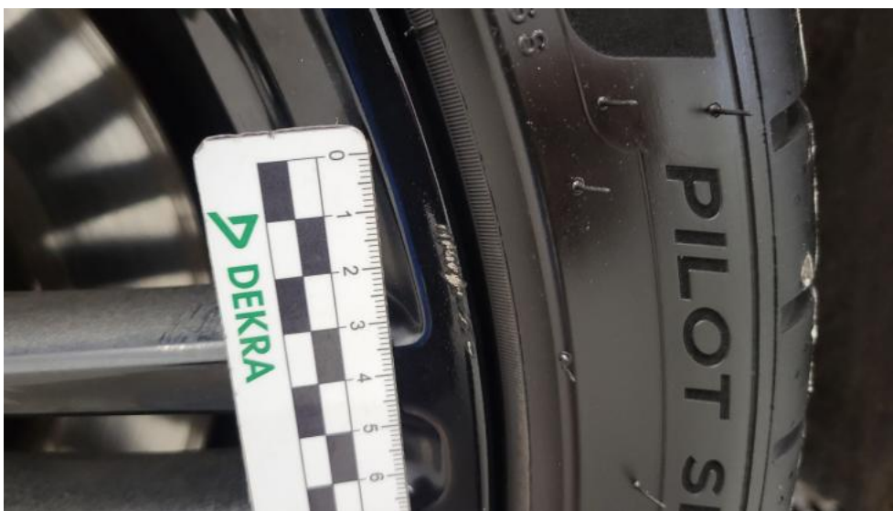
Photo 69. Felga aluminiowa tylna L() - Rysa/odprysk 3
