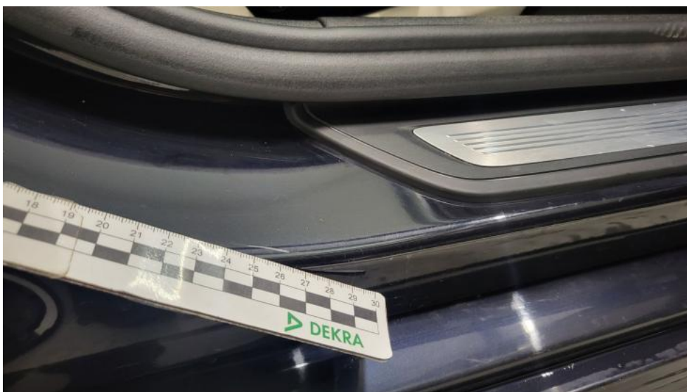
Photo 60. Próg P - Rysa/odprysk 1
