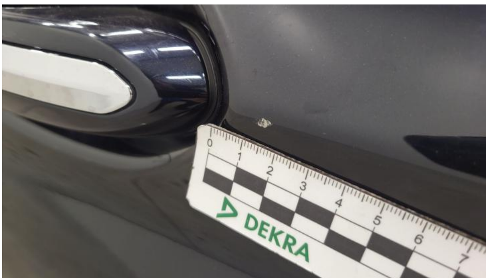
Photo 71. Drzwi tylne L - Rysa/odprysk 1
