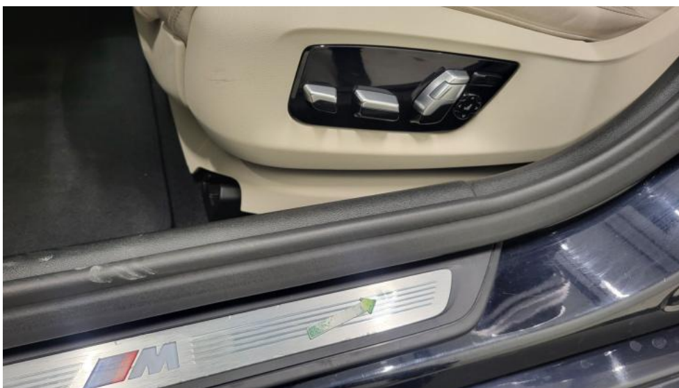
Photo 73. Próg L - Wgniecenie/odkształcenie 1
